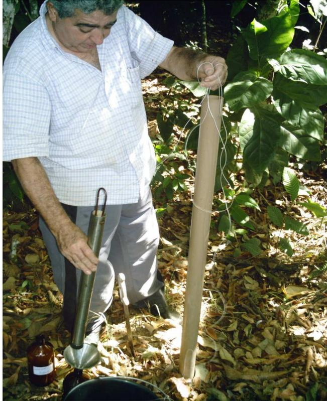
Figura 6 - Piezômetro instalado na área de estudo
