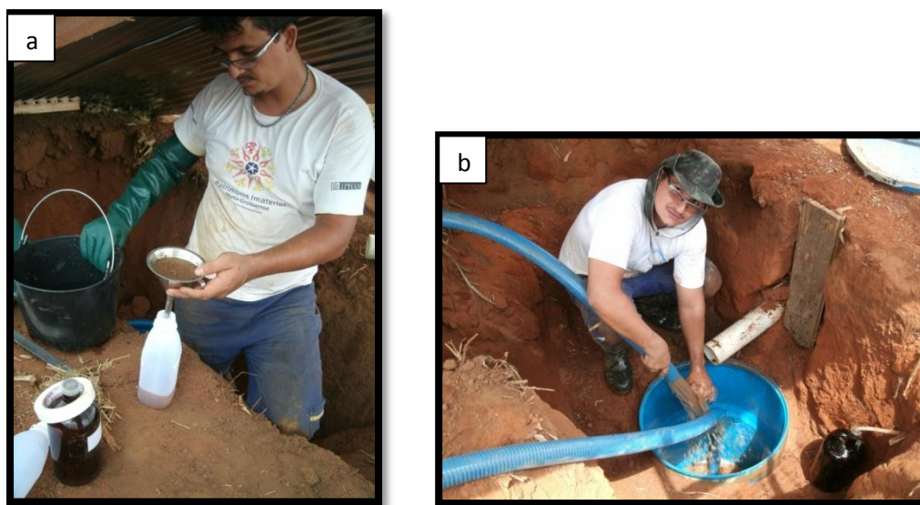
Figura 15: a) Métodos de coleta dos materiais em campo coleta manual, e b) coleta por intermédio da Motobomba ZB-50.
