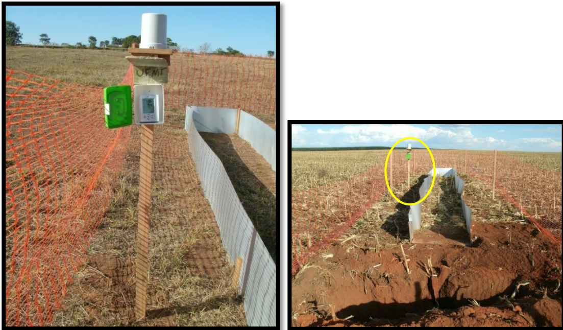
Figura 11: Pluviômetro Digital instalado na Parcela de Erosão 01 e destacado na Parcela 05. Fonte: JESUZ, C. R., 2013.
