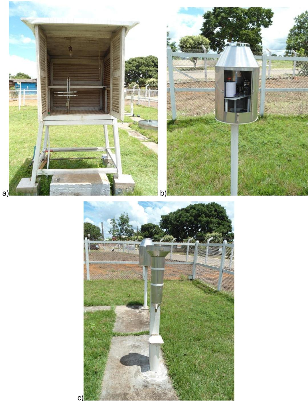
Figuras 4: Instrumentos usados na estação meteorológica convencional na cidade de Vera-MT. a) Abrigo Meteorológico (Termômetros), b) Pluviógrafo, c) Pluviômetro.
