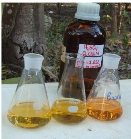
**Figura 9** - Ponto de viragem na determinação da alcalinidade
