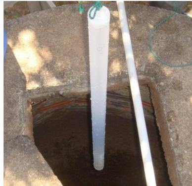
**Figura 7** - Coleta de água subterrânea utilizando amostrador manual
