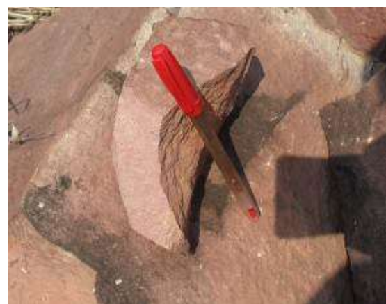
Figura 76 – Detalhe de amostra de arenito com grãos unidos por silicificação diagenética.
