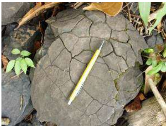
Figura 58 - Bloco de basalto com juntas de contração, formando um aspecto de “casco de tartaruga”.
