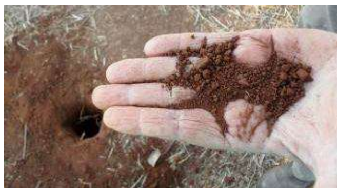
Figura 13 – Detalhe de amostra de solo coletado de Latossolo Vermelho Escuro, contendo típica estrutura microagregada.
