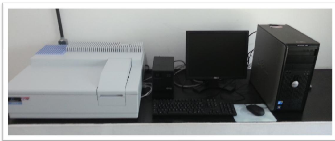
FIGURA 7. Foto do Espectrofotômetro PerkinElmer, modelo Lambda 25.
