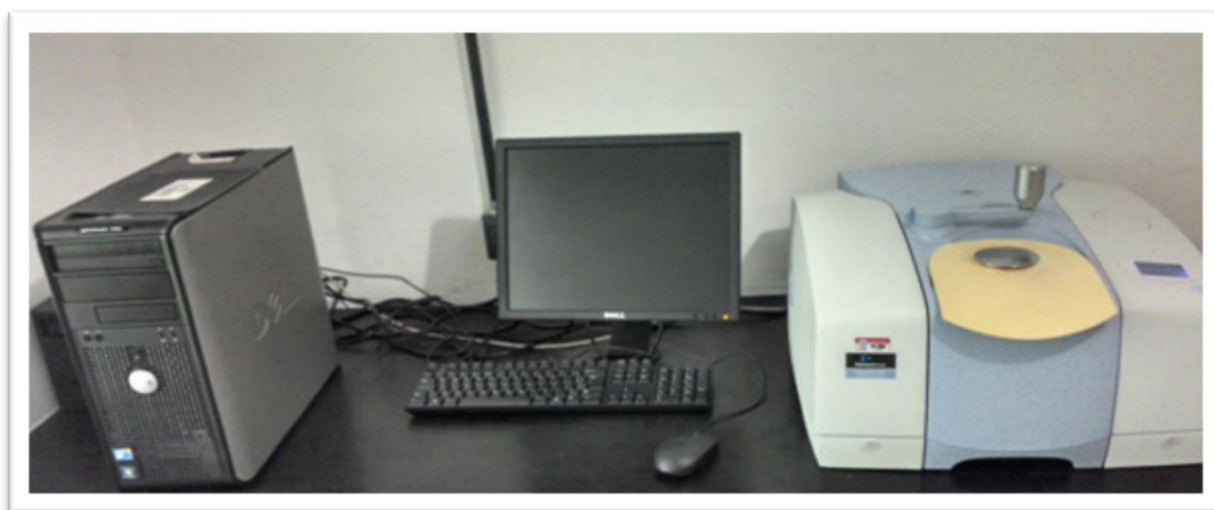
FIGURA 6. Foto do Espectrofotômetro PerkinElmer, modelo Spectrum 100.
