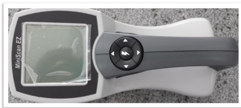
FIGURA 12. Foto do Espectrofotômetro BrasEq® modelo MiniScan EZ Hunterlab. Os testes foram realizados em triplicata e a diferença total de cor foi obtida segundo a equação abaixo:
