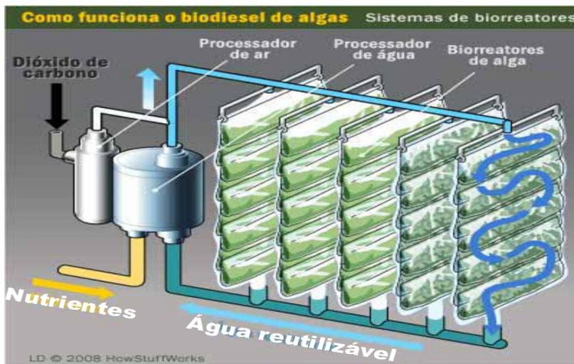
Figura 5: Biorreator vertical. Fonte: <http://carros.hsw.uol.com.br/biodiesel-de-algas3.htm>.Figura
