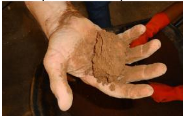
Figura 30 – Determinação da umidade ótima por meio de teste táctil-visual.
