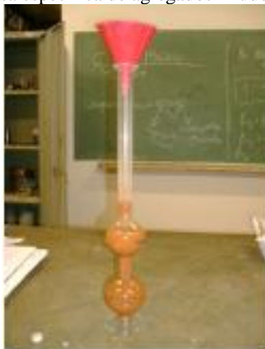
Figura 16 – Determinação da massa específica de agregados miúdos pelo método do frasco Chapman .
