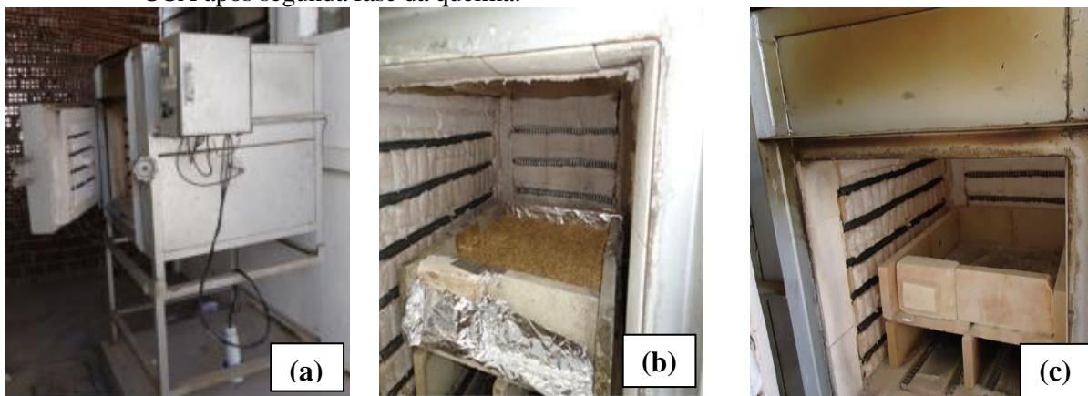
Figura 23 – Queima da casca de arroz: (a) forno, (b) CA em caixa adaptada no interior do forno, (b) CCA após segunda fase da queima.
