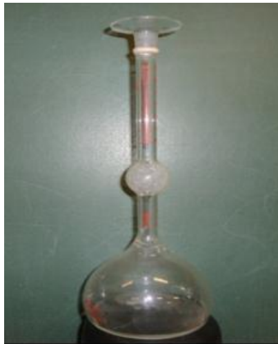
Figura 14 – Frasco volumétrico de Le Chatelier usado no ensaio de massa específica do cimento.
