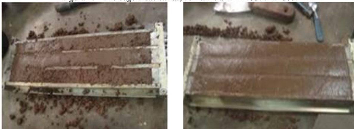
Figura 17 – Moldagem das barras, conforme a NBR 15577-4/2008.
