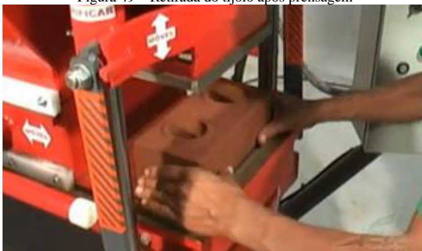
Figura 49 – Retirada do tijolo após prensagem
