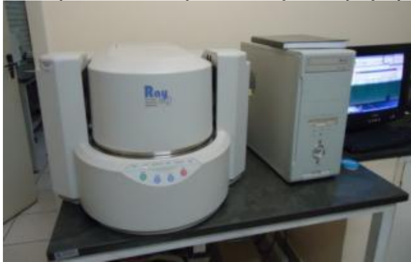
Figura 13 – Espectrômetro utilizado para a determinação da composição química.
