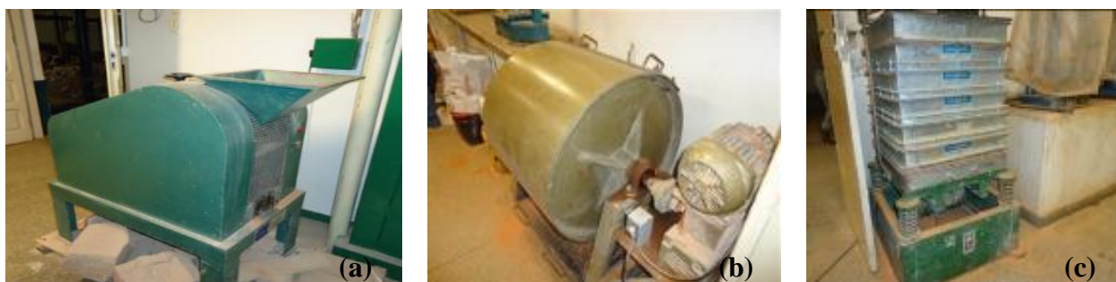
Figura 15 – Equipamentos para o processamento dos agregados: (a) britador de mandíbula, (b) moinho de bolas, (c) conjunto de peneiras.
