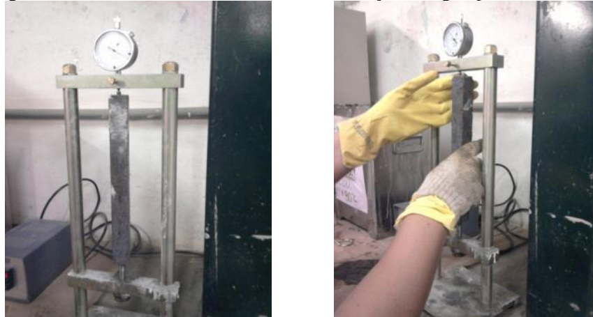
Figura 18 – Leitura das barras: ensaio de absorção de água pelo ARTC
