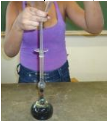
Figura 25 – Ensaio de massa específica de CCA, método Le Chatelier .
