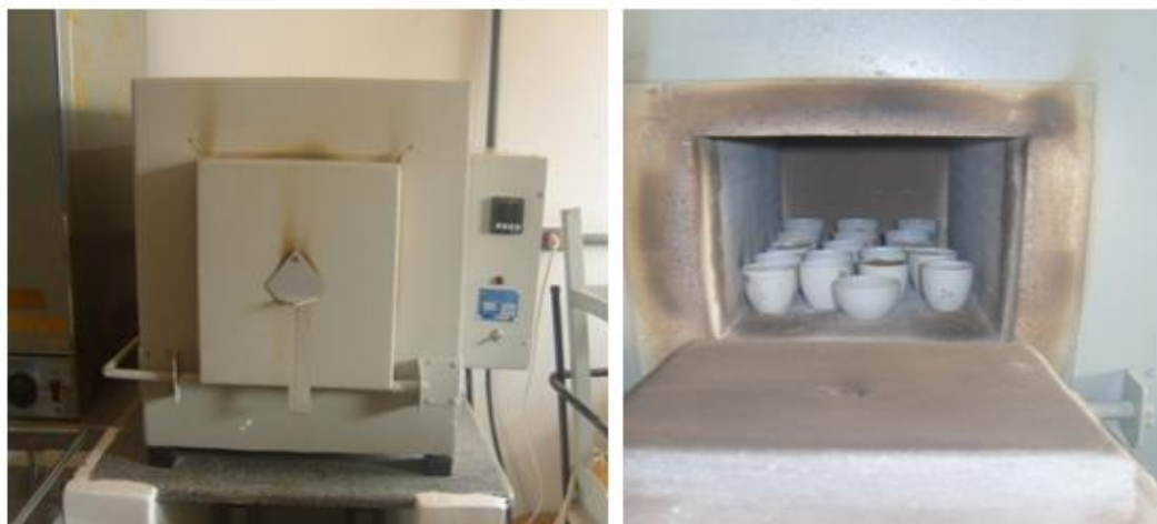
Figura 10. Foto da mufla utilizada para calcinação das amostras de folha da Curatella americana L. (FEN - UFMT).
