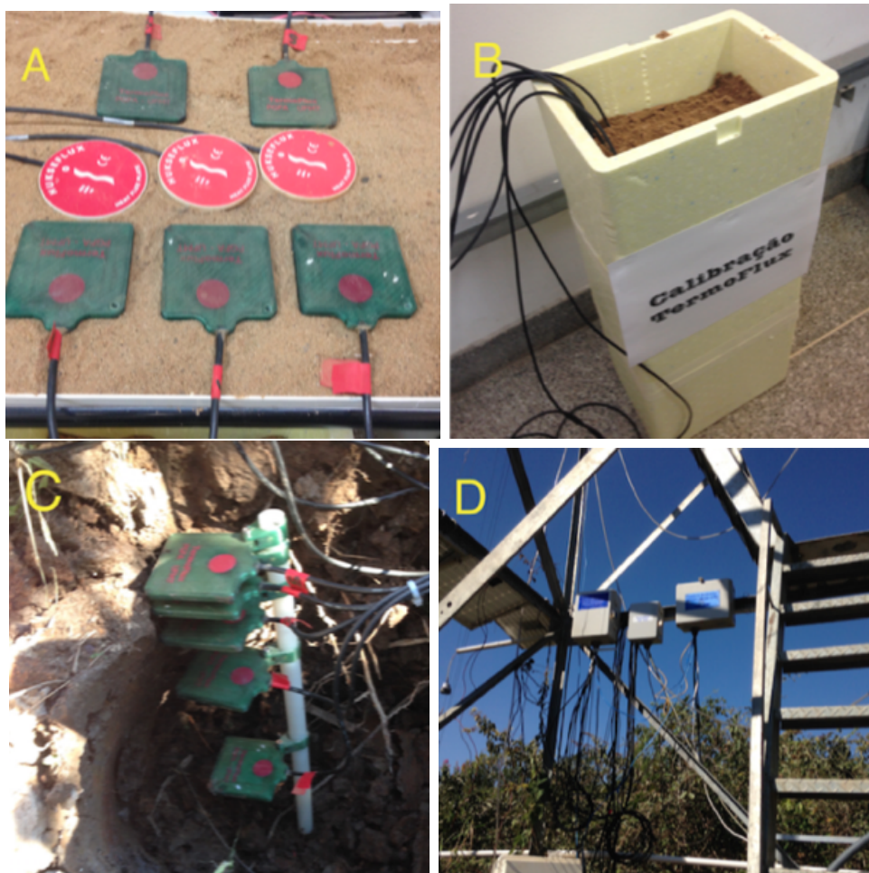
Figura 22: As duas imagens superiores são os testes feitos em laboratório e as imagens inferiores a instalação no campo (Baía das pedras).
