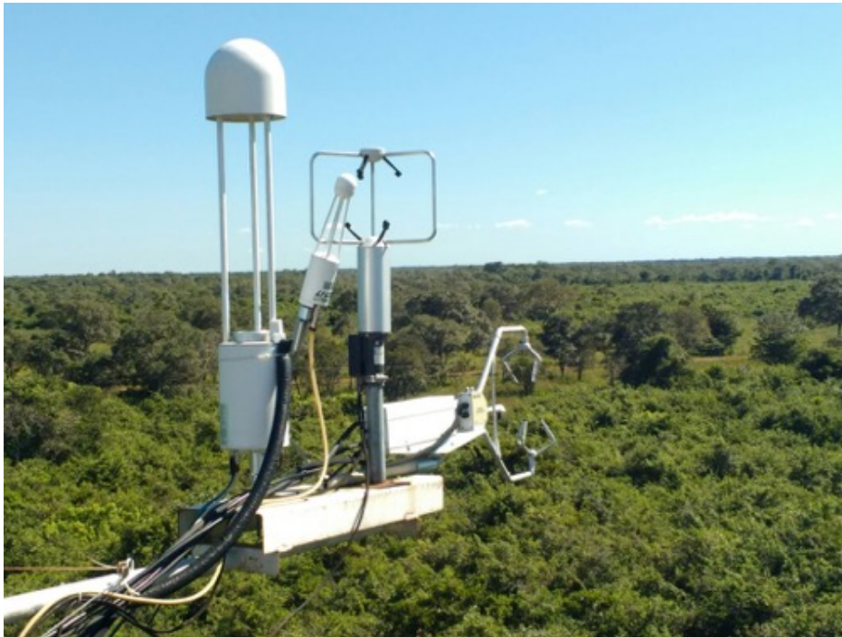
Figura 4: Sistema de Covariância de Vórtices Turbulentos, instalados na torre do pantanal 2.2.
