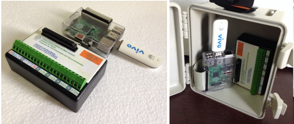
Figura 23: O datalogger alternativo, o circuito com os ADC's ligado ao raspberry pi e todos os softwares instalados em duas versões 8 canais e 16 canais, a montagem em caixa a prova d'água e testes com diversos sensores.
