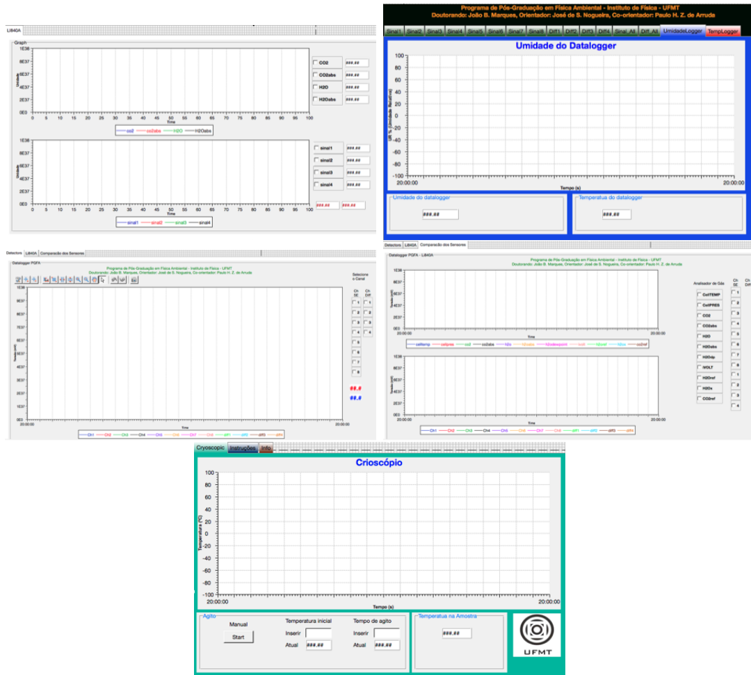
Figura 24: Tela de ambientes gráfico de monitoramento em tempo real, totalmente integrado com o EPICS e datalogger alternativo baseado em PC.
