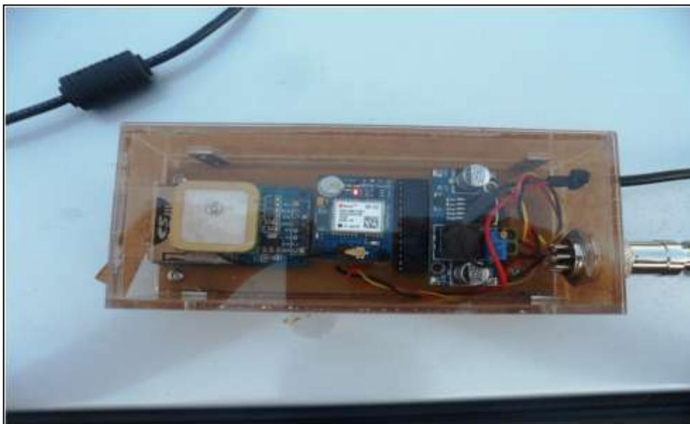
Figura 4: Datalogger GK\_V02 com GPS com Módulo GY-GPS6MV2
