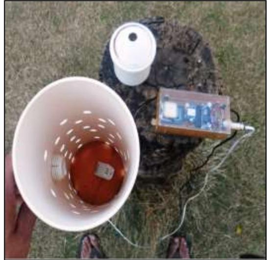
Figura 6: Abrigo termométrico
