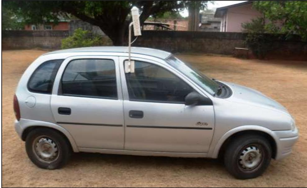
Figura 7: Veículo automotor utilizado acoplado com abrigo termométrico e datalogger
