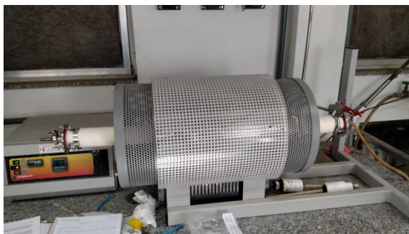
Figura 4.5 - Forno tubular onde foram preparadas as amostras numa atmosfera de 95% de argônio e 5% de hidrogênio no CBPF (ilustração do autor).
