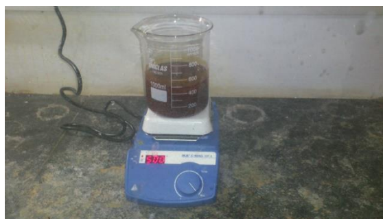
Figura 4.3 – A mistura III se encontra dentro da capela na chapa elétrica à 500 °C por 5 horas (ilustração do autor).
