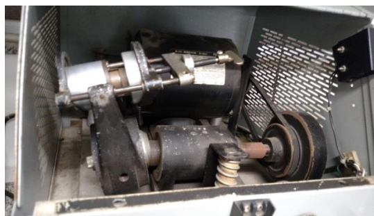
Figura 4.4 - Moinho de bolas Spex 8000 utilizado para moagem das amostras no CBPF (ilustração do autor).
