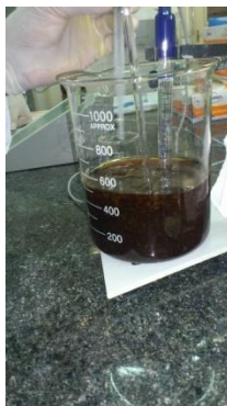
Figura 4.2 - Misturando com um conta gota a solução I com a solução II com o p.H controlado em 7 (ilustração do autor).
