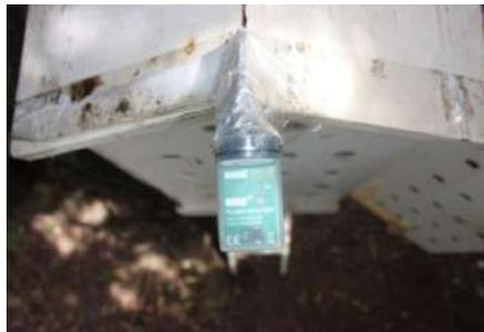
**Figura 33** – Sensor HOBO UA002-64 de iluminância externa fixado em posição horizontal em abrigo meteorológico
