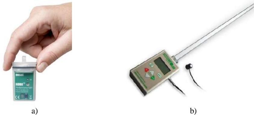
**Figura 27** – Sensor HOBOTest UA002-64 de iluminância externa (a) e Ceptômetro de Barra (b)
