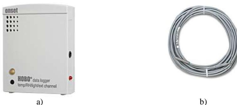
**Figura 26** - Sensor HOBO U12-012 de temperatura de bulbo seco do ar, umidade relativa do ar e iluminância (a) e cabo TMC20HD com sensor de temperatura (b)
