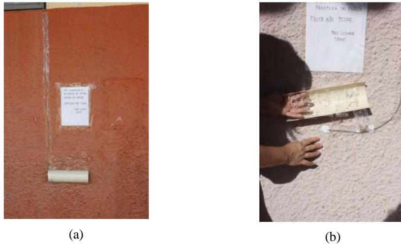
**Figura 36** – Cabo TMC20HD com sensor para medição de temperatura superficial nas paredes externas proteção com tubo de 100mm de diâmetro cortado ao meio (a) e detalhe da fixação na parede (b)
