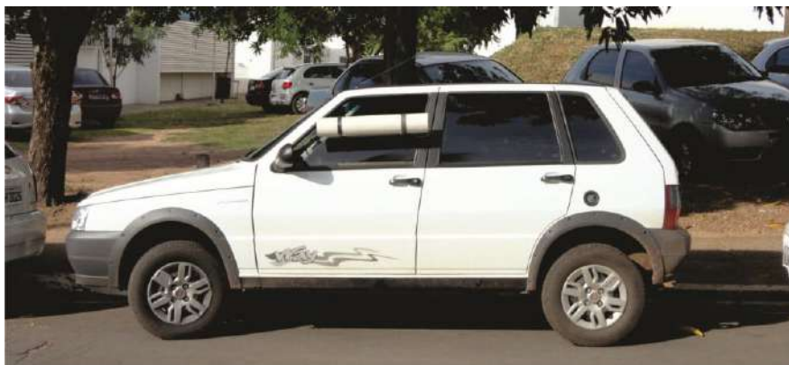
Figura 33 - Abrigo em cano de PVC instalado no vidro do veículo utilizado nos transectos móveis.
