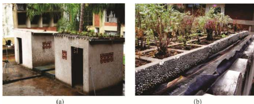
Figura 14 – (a) Protótipos com telhado instalado e (b) detalhe aproximado das telhas vegetadas Fonte: Adaptado de Rosseti (2009)
