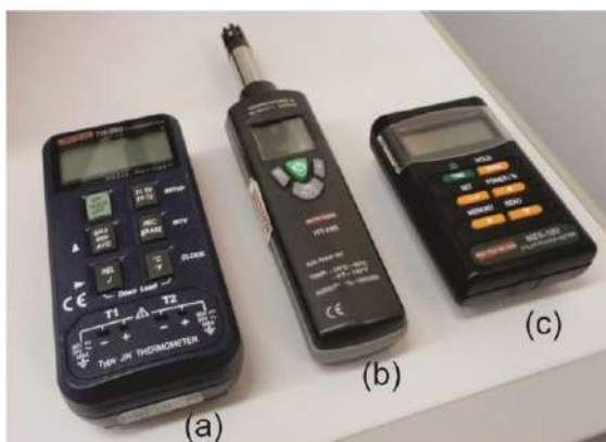
Figura 32 - Equipamentos de medição das variáveis microclimáticas: (a) Termômetro Digital Portátil, (b) Termo-Higrômetro Digital Portátil e (c) Medidor de Energia Solar.
