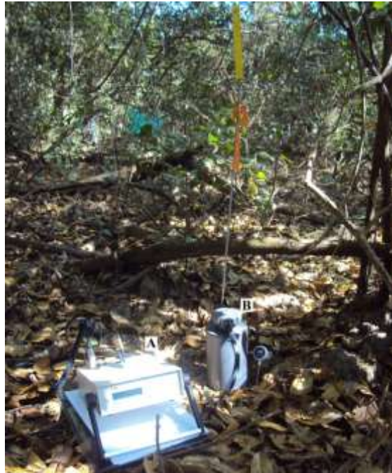
Figura 4. (A) Analisador de gás por infravermelho tipo sistema fechado (EGM-4) e (B) câmara respiração do solo (SRC-1).
