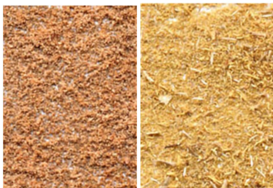
Figura 5 ĩ Agregado leve vegetal: (a) Pó-de-serra granular; (b) Pó-de-serra fibroso.
