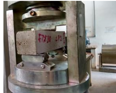
Figura 72 - Execução do ensaio de tração por flexão, após a realização do ensaio de ultrassom.
