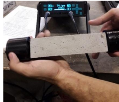
Figura 70 - Execução do ensaio de ultrassom em corpos de prova prismáticos.
