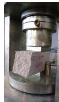
Figura 76 - Execução do ensaio de compressão nas amostras de argamassa após a ruptura por flexão.
