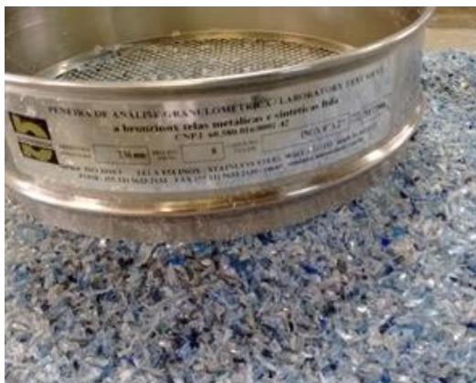
Figura 30 ĩ Peneiramento do PET em malha 2,36mm.
