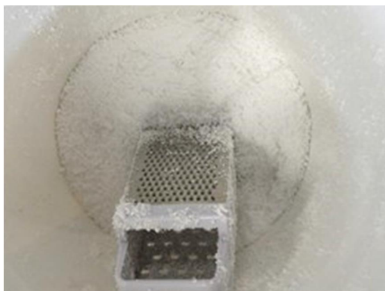
Figura 32 ĩ Trituração do EPS em ralador doméstico.
