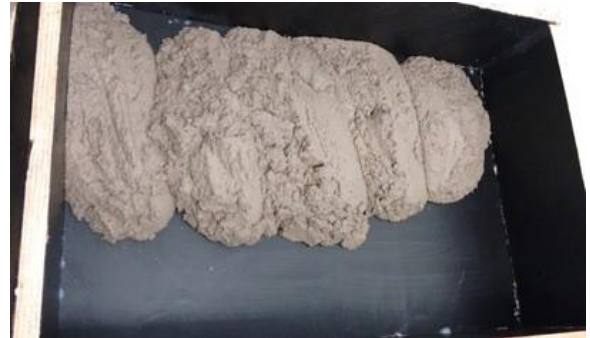
Figura 80 ĩ Espalhamento da argamassa de revestimento da face inferior do prisma.
