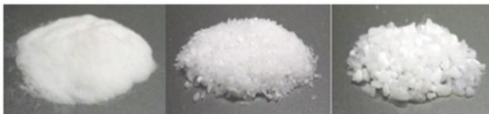
Figura 19 - Aerogel de sílica híbrido moído e peneirado, com diferentes granulometrias.
