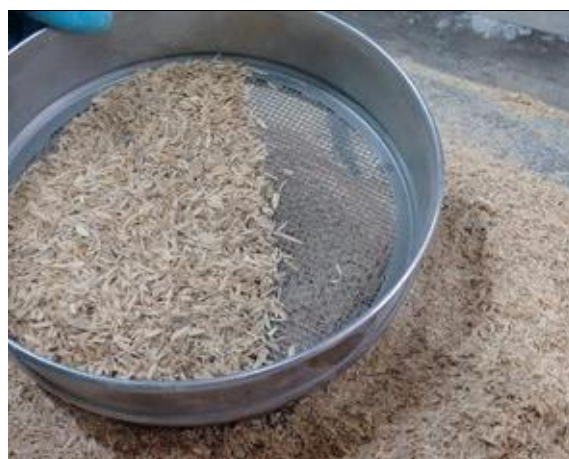
Figura 27 i Peneiramento da palha de arroz em malha 2,36mm.
