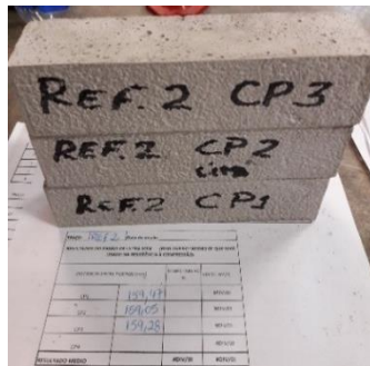
Figura 73 - Corpos de prova prismáticos antes do ensaio de tração por flexão
