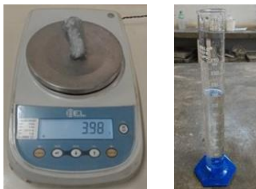
Figura 49 i Determinação da massa específica do EPS (em água).
