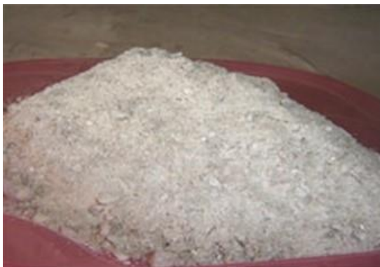
Figura 16 i Resíduo do processamento do caulim (birra).
