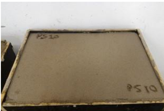
Figura 83 ĩ Deposição da camada superior da argamassa de revestimento.
