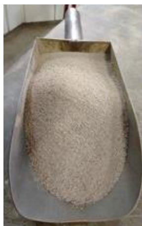
Figura 40 - RCD após britagem e peneiramento.
