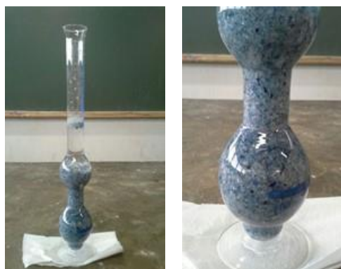
Figura 51 i Determinação da massa específica do PET (em água).
