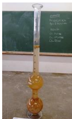
Figura 47 i Determinação da massa específica da palha de arroz (em água).
