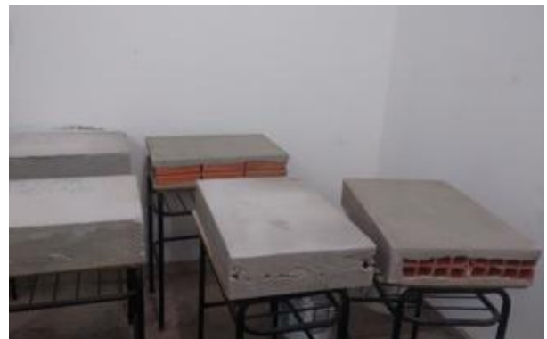
Figura 84 ĩ Prismas após a desmoldagem.
