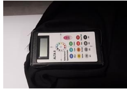
Figura 91 ĩ Medição da irradiação refletida pela referência (papel branco 75 g/m 2 )
