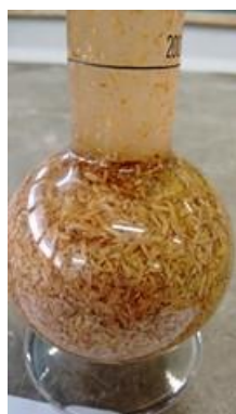
Figura 47 i Determinação da massa específica da palha de arroz (em água).
