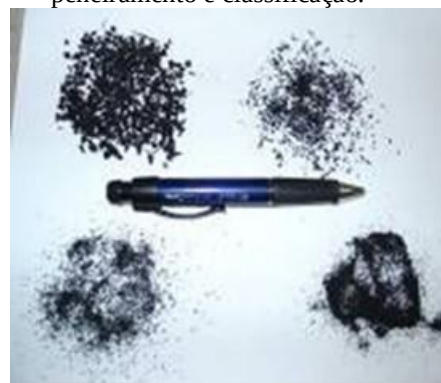
Figura 14 ĩ Raspas e pó de pneu após peneiramento e classificação.
