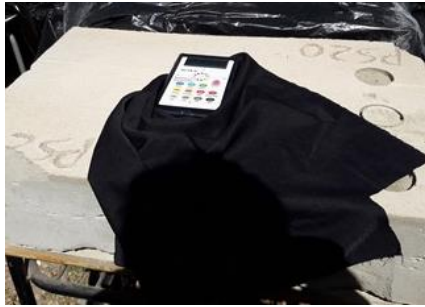
Figura 90 ĩ Medição da irradiação refletida pela amostra por meio do equipamento ALTA II
