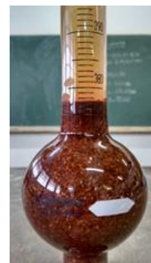
Figura 48 i Determinação da massa específica do pó de serra (em água).
