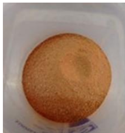
Figura 41 ĩ Cerâmica vermelha após britagem e peneiramento.
