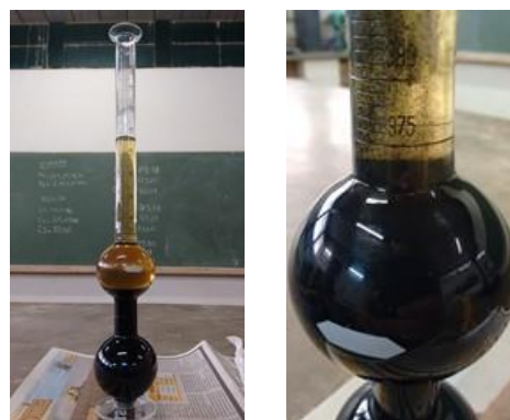
Figura 50 i Determinação da massa específica das raspas de pneu (em álcool).
