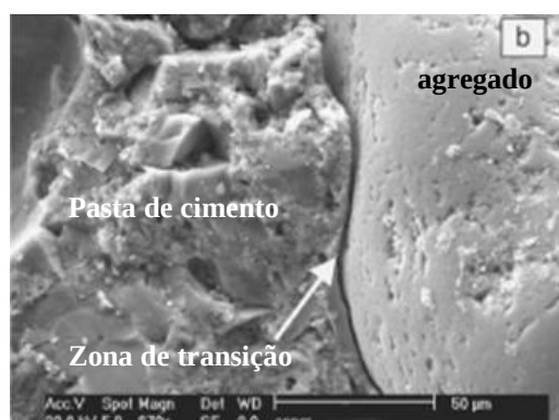
Figura 104 ĩ Zona de transição entre a pasta de cimento e o agregado natural.
