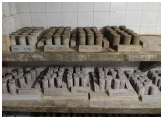
Figura 62 ĩ Cura ao ar das amostras de argamassa.
