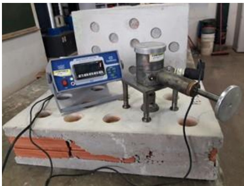
Figura 87 ĩ Equipamento utilizado para o arrancamento da argamassa e verificação da carga de ruptura.
