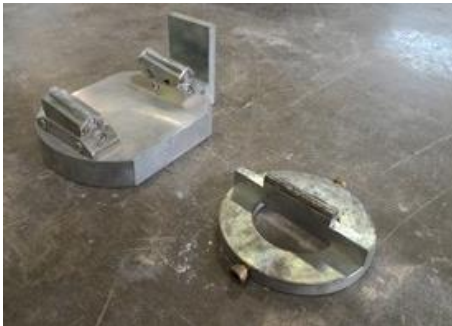
Figura 71 - Placas inferior e superior para realização do ensaio de tração por flexão.
