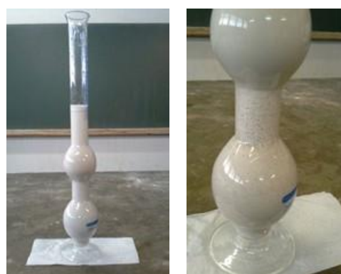
Figura 54 i Determinação da massa específica do pó de vidro (em água).
