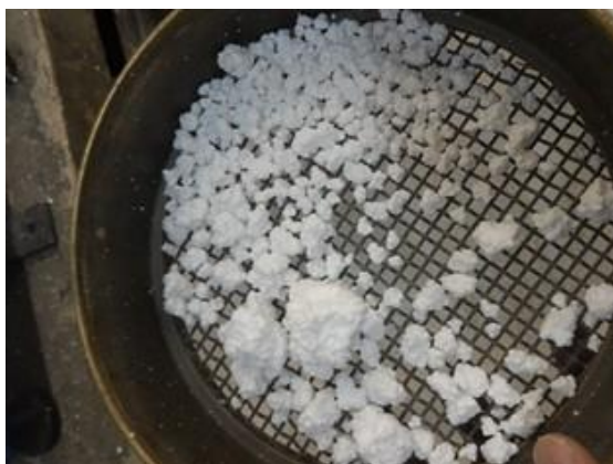
Figura 34 ĩ Peneiramento do EPS em malha 4,8mm.
