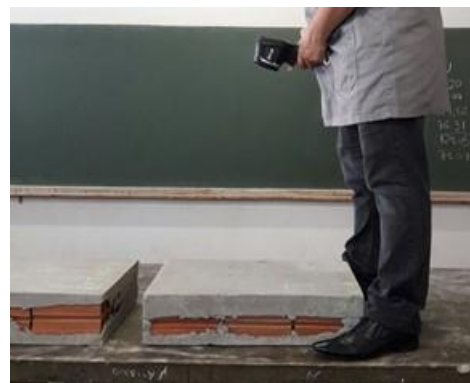
Figura 93 ĩ Posicionamento para verificação da temperatura superficial.
