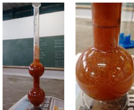
Figura 52 i Determinação da massa específica da cerâmica vermelha (em água).
