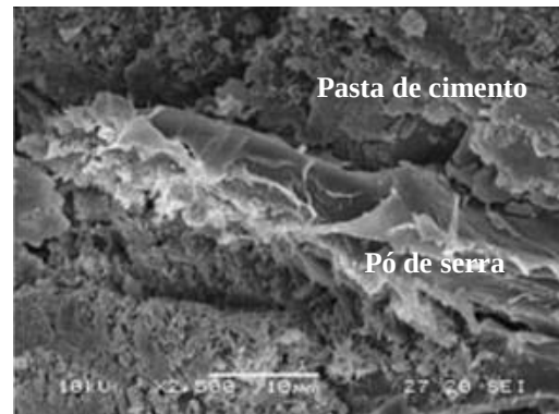
Figura 107 ĩ Zona de transição entre a pasta de cimento e o pó de serra (eucalipto).
