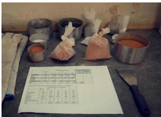
Figura 55 ĩ Traços separados para os testes de consistência.
