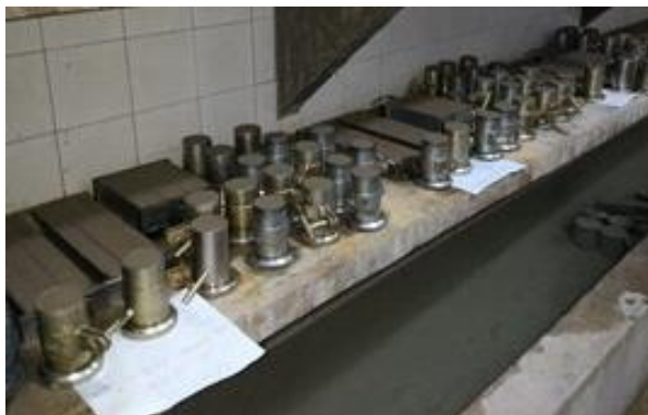
Figura 61 ĩ Amostras de argamassa moldadas.
