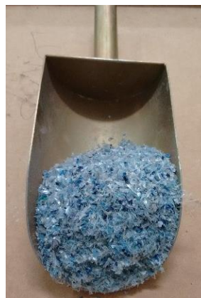
Figura 31 ĩ Aspecto do resíduo de PET após peneiramento.
