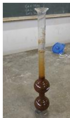
Figura 48 i Determinação da massa específica do pó de serra (em água).
