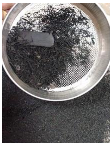
Figura 36 ĩ Peneiramento das raspas de pneu em malha 2,36mm.
