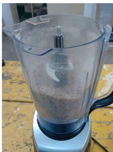
Figura 26 i Trituração da palha de arroz em liquidificador de três hélices.
