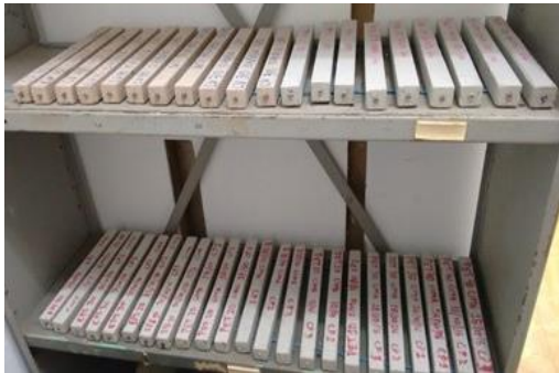
Figura 77 - Amostras de retração sob cura ao ar, dispostas sobre fios a fim de garantir as faces livres.
