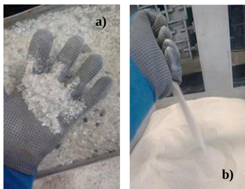
Figura 44 ĩ Resíduo de vidro: a) após britagem; b) após moagem e peneiramento na malha 1,2mm.
