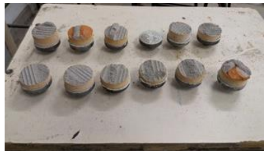
Figura 88 ĩ Avaliação do tipo de fratura após o arrancamento da argamassa.
