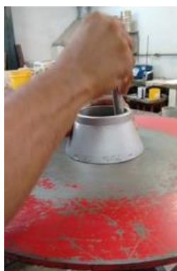
Figura 57 i Moldagem da argamassa na mesa de consistência.
