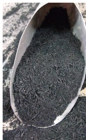
Figura 37 ĩ Aspecto do resíduo de pneu após peneiramento.
