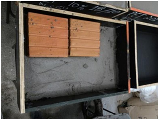
Figura 81 ĩ Disposição dos blocos cerâmicos sobre a argamassa.
