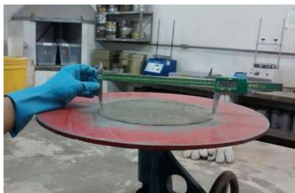
Figura 58 i Verificação da consistência da argamassa.
