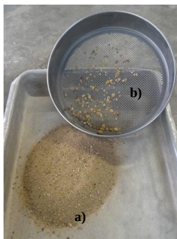
Figura 25 ĩ Areia natural: a) material passante na #2,36mm; b) material retido na # 2,36mm.
