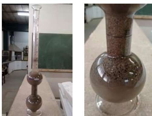
Figura 53 i Determinação da massa específica do RCD (em água).
