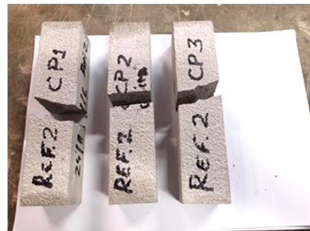
Figura 74 - Corpos de prova prismáticos após o ensaio de tração por flexão
