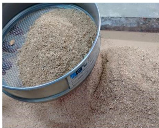
Figura 29 i Peneiramento do pó-de-serra em malha 2,36mm.
