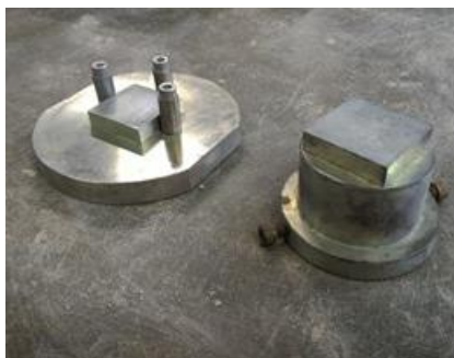
Figura 75 - Placas e inferior e superior para realização do ensaio de compressão nas amostras de argamassa após a ruptura por flexão
