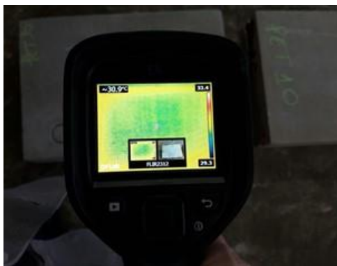
Figura 92 ĩ Verificação da temperatura superficial por meio do termograma.
