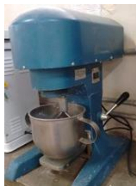
Figura 56 ĩ Mistura dos materiais na argamassadeira.
