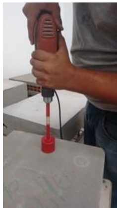
Figura 87 ĩ Equipamento utilizado para o arrancamento da argamassa e verificação da carga de ruptura.
