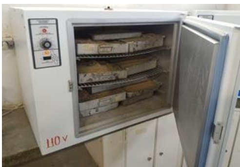
Figura 59 ĩ Secagem da areia em estufa.
