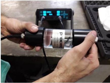
Figura 69 - Calibração do equipamento para realização do ensaio de ultrassom.
