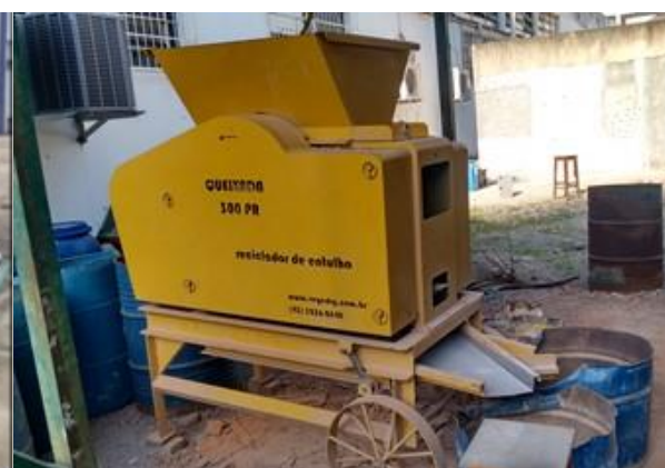
Figura 39 ĩ Equipamento usado para a britagem do RCD e da cerâmica vermelha.
