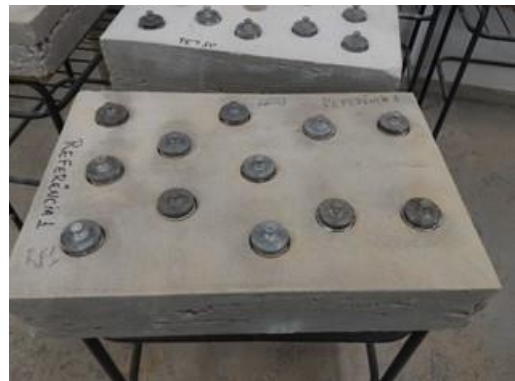
Figura 86 ĩ Colagem das pastilhas metálicas para o ensaio de aderência.
