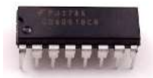
Figura 17. Multiplexador analógico CD4051 usado para construção do datalogger das estações micrometeorológicas.
