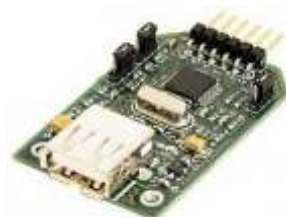
Figura 18. Módulo embarcado PenBS usado para construção do datalogger das estações micrometeorológicas.
