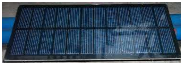
Figura 20. Painel solar de 5W utilizado para carregar as baterias das estações micrometeorológicas.
