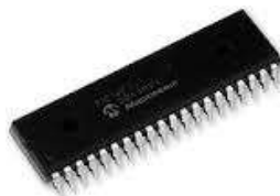
Figura 15. Microcontrolador 18f452 usado para construção do datalogger das estações micrometeorológicas.
