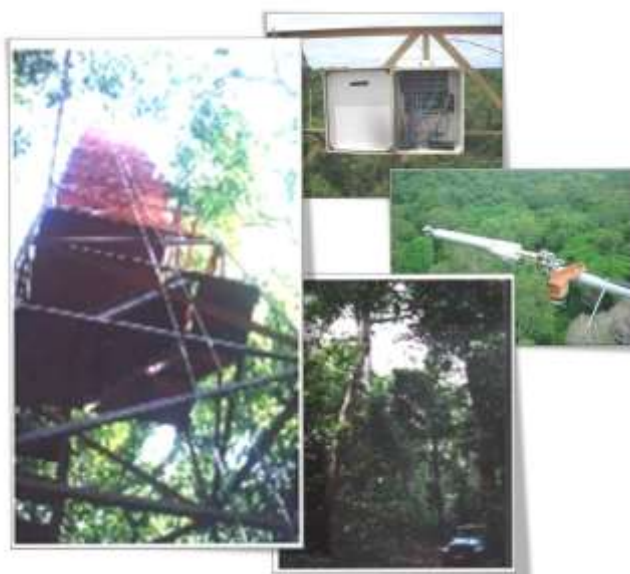
Figura 2. Torre da área de estudo com 42 metros de altura, a floresta, o net radiômetro e o datalogger na Fazenda Maracaí, em Sinop. Fonte: ARRUDA (2011).
