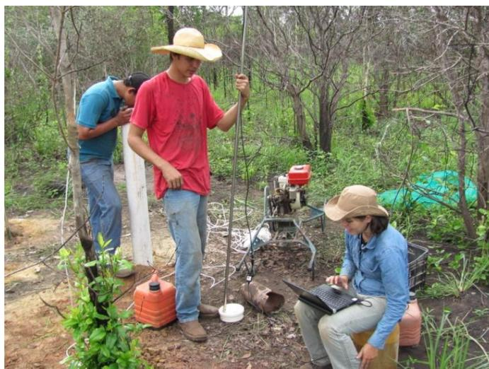
**Fig. 3** Sensor de nível freático instalado na “Cordilheira” (modelo WT-HR 2000, da TruTrack Data Loggers)
