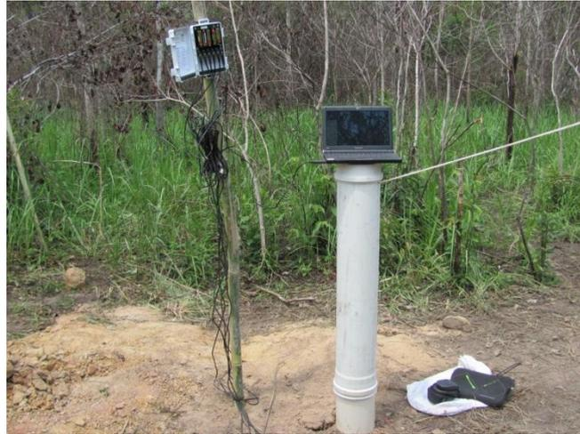
**Fig. 2** Datalogger do sensor de umidade instalado no ‘Cambará jovem’ (modelo Em50, da Decagon Device)
