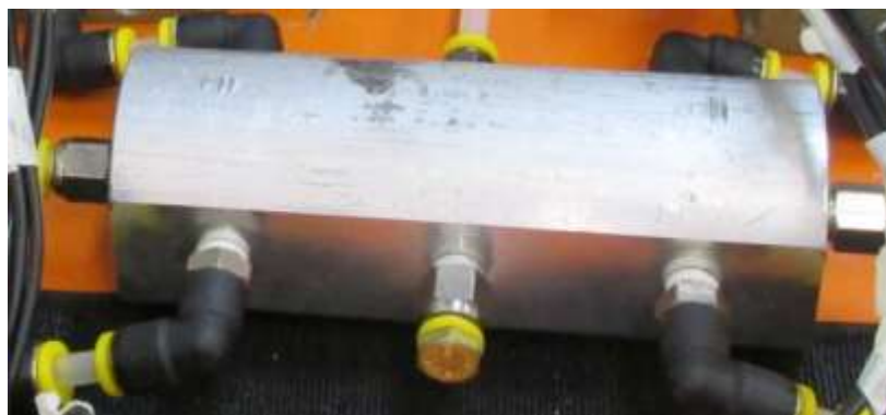
Figura 22: Tudo de distribuição (manifold).
