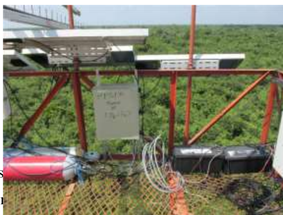
Figura 45: Sistema de perfil atmosférico de CO 2 e H 2 O instalado na torre.
