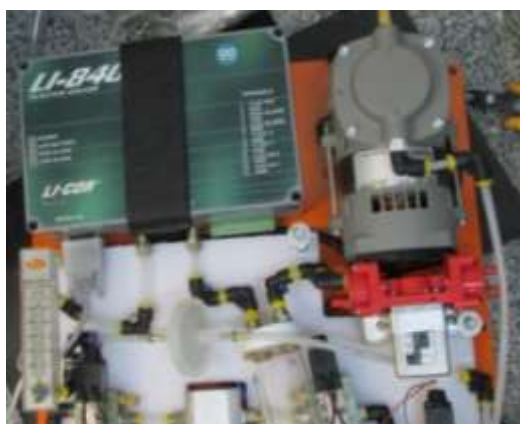
Figura 40: Disposição dos equipamentos do sistema de perfil atmosférico \text{CO}_2 e \text{H}_2\text{O} . A - LI-840A; B - Rotâmetro; C - Filtro de Ar; D - Bomba AC; E - Bomba DC; F - Recipiente de amortecimento; G - Manifold; e H - Válvulas Solenoides.
