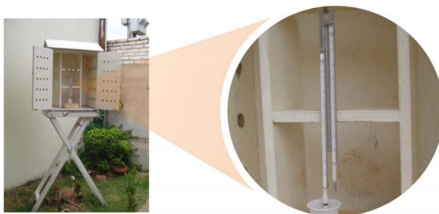
Figura 3 - Abrigo de madeira com furos – uso de psicrômetro Fonte: Oliveira B (2007)
