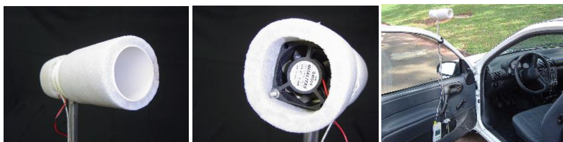
Figura 6 – Abrigo horizontal com ventilação forçada para medições
