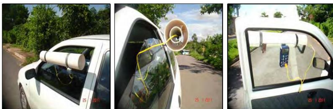
Figura 5- Abrigo horizontal em PVC para medições
