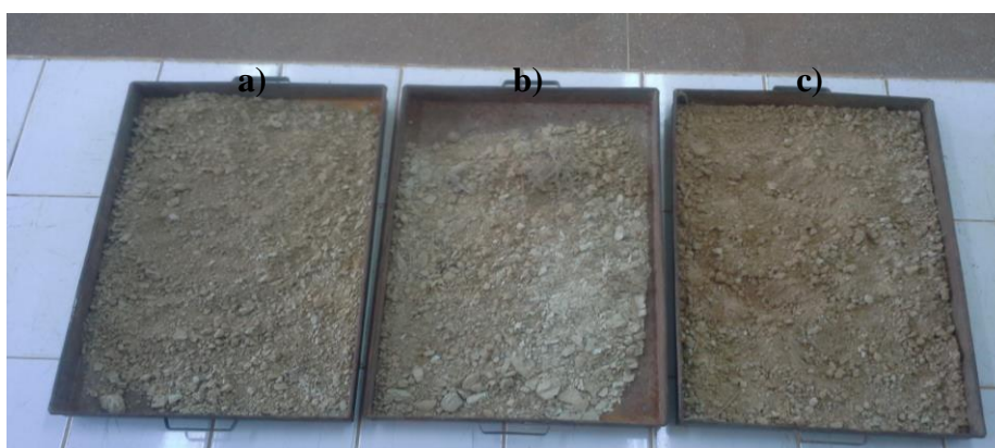
Figura 11 - Amostras de solo utilizado na camada de cobertura do talude (a); Parcelas no talude sem vegetação (b); e solo com vegetação ( P. notatum ) do ASIC (c).
