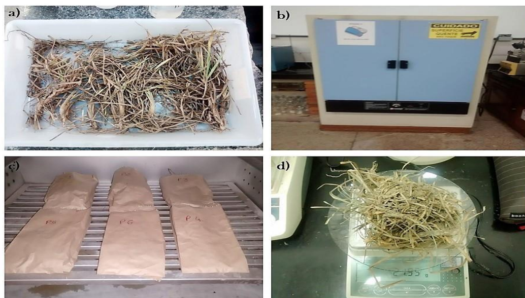
Figura 16 - Determinação da massa seca: a) lavagem dos indivíduos com água destilada; b) estufa na qual eram acondicionadas as amostras; c) indivíduos armazenados em sacos de papel para secagem em estufa; d) pesagem dos indivíduos após 72h.
