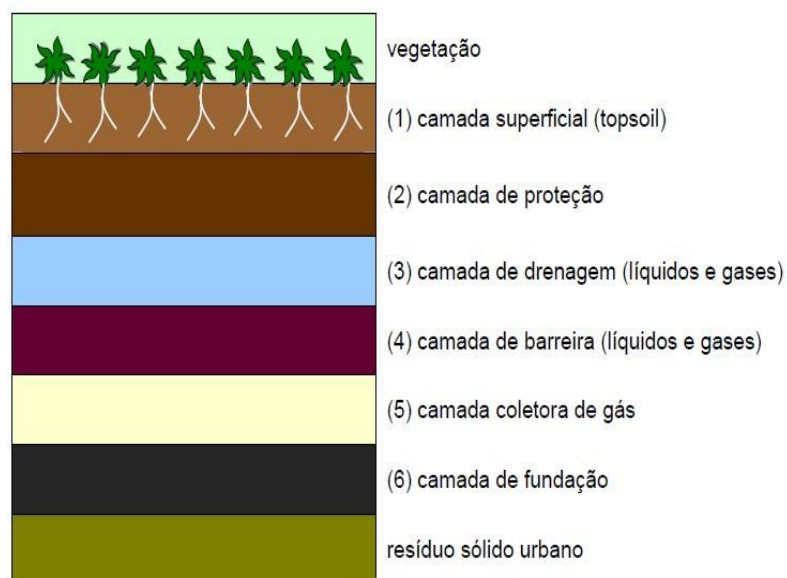
Figura 02 – Ordenação dos componentes da camada de cobertura de um Aterro Sanitário.
