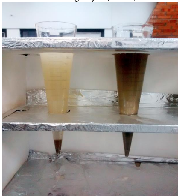
Figura 27 – Amostras de sedimento carregado, coletados nas células com vegetação (esquerda) e sem vegetação (direita).
