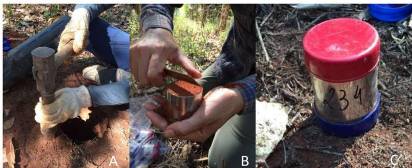
FIGURA 6- COLETA DE SOLO INDEFORMADA. CASTELINHO, MARRETA E ANEL UTILIZADOS PARA COLETA (A); TOALETE FEITO NOS ANÉIS PARA NÃO ULTRAPASSAR O VOLUME (B); ANEL VOLUMÉTRICO DE KOPECK, DEVIDAMENTE TAMPADO PARA ENCAMINHAR AO LABORATÓRIO (C)
