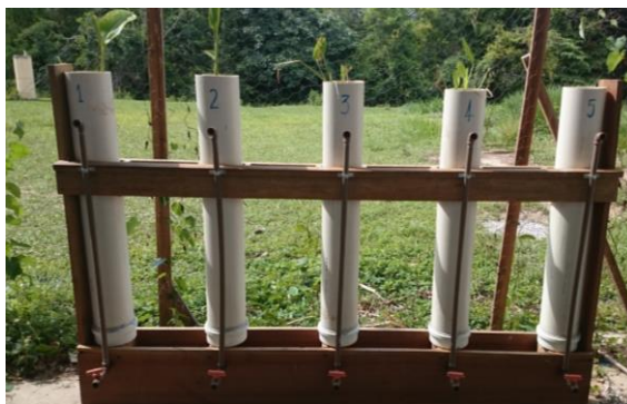
Figura 16: Sistemas de Wetlands Construídos Fonte: Ito (2018)
