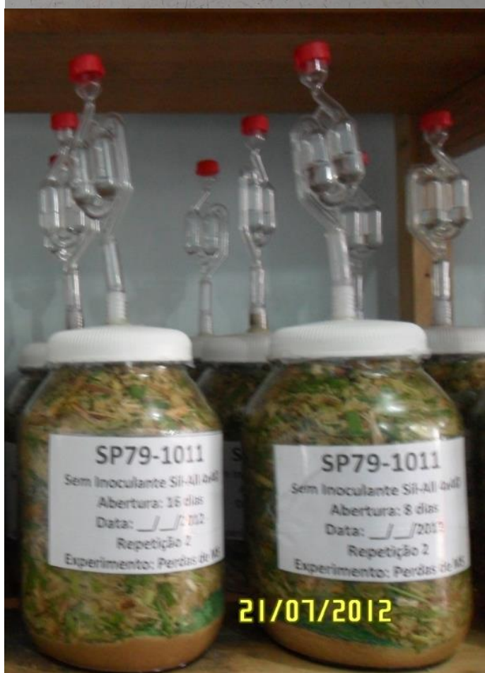
FIGURA 2. Silos experimentais prontos para uso (A) e compondo o experimento de determinação de perdas de matéria seca (B).
