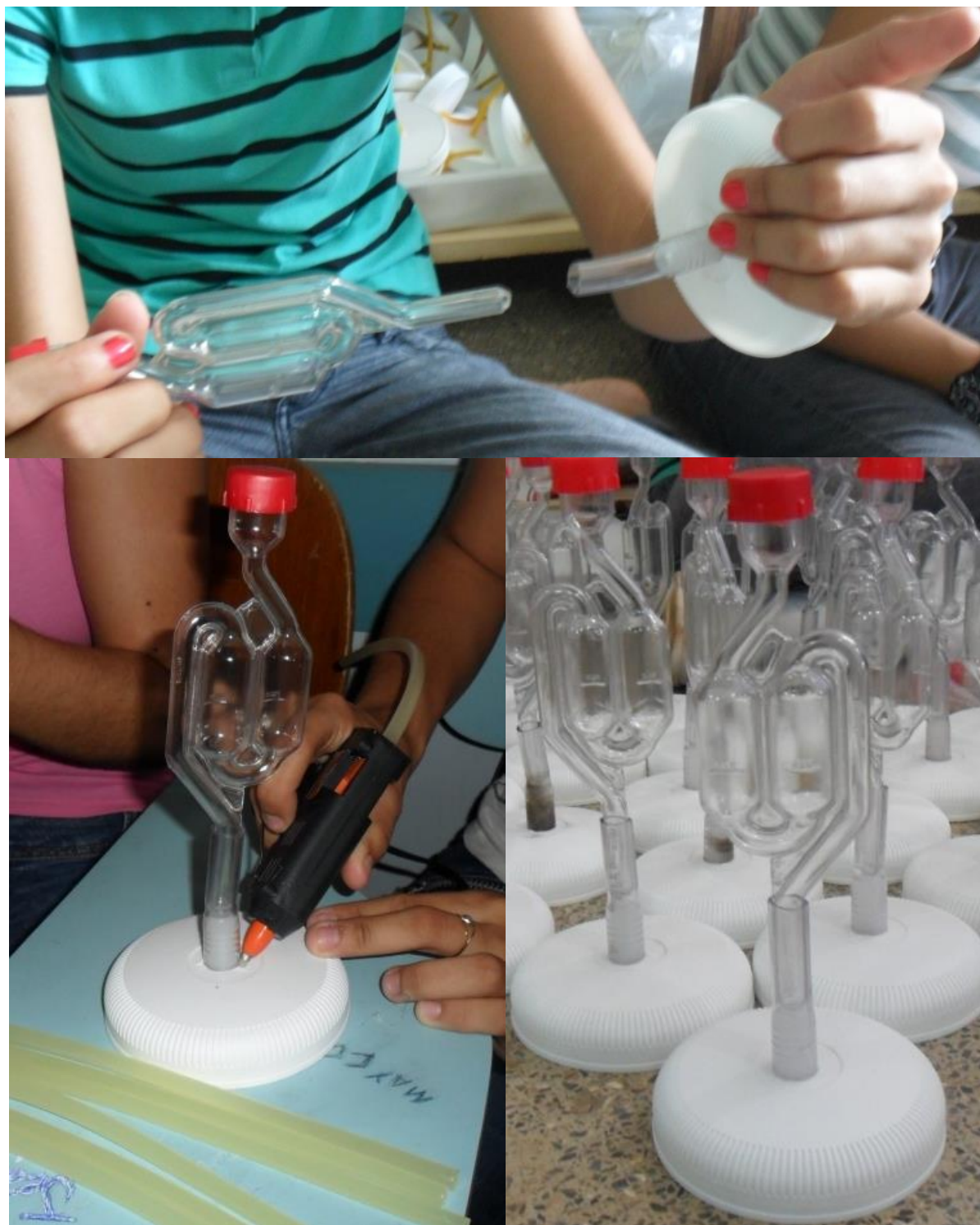
FIGURA 1. Montagem das tampas com válvula “sifão”.
