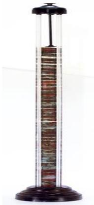
Figura VI – Pilha de Alessandro Volta
