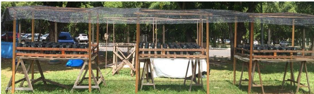
As mesas construídas para o experimento consistiram em armações de madeira e ferro, de modo que existissem 66 lugares para que os lisímetros pudessem ser colocados (totalizando assim 198 lugares). As mesas foram nomeadas como A, B e C.
