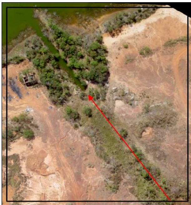
Figura 34 - Detalhe da figura 31 C. Migração subsuperficial de efluentes do aterro sanitário para o reservatório.
