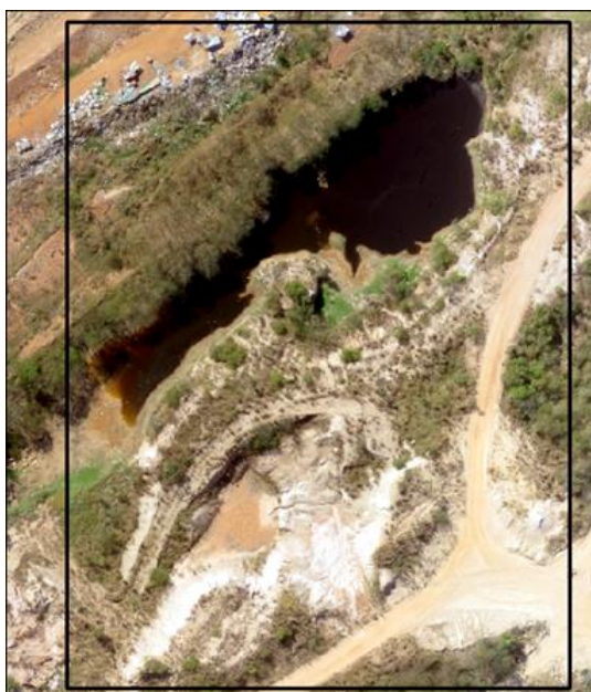
Figura 33 - Detalhe da figura 31 B. Vazamento de chorume na face sudeste do aterro sanitário. Área de substrato metarenítico de textura granular, com alta porosidade e permeabilidade (redes de veios de quartzo preenchendo fraturas), aumentando o potencial de infiltração do poluente para o aquífero.
