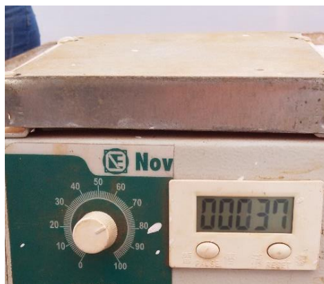
Figura 7. Equipamento regulador de oscilações com display de leitura de oscilações acoplado.
