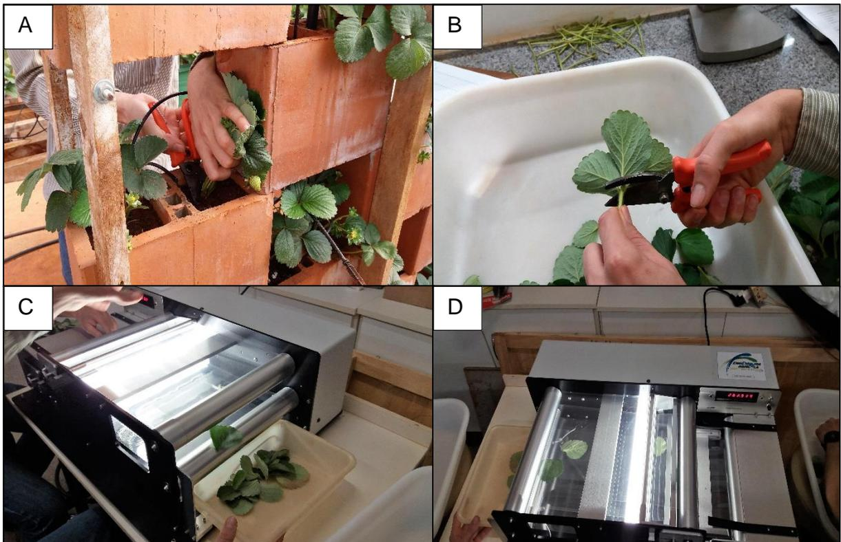
**Figura 18.** (A) Hojas de fresa siendo cortadas para evaluación de área foliar, (B) separación de hojas y pecíolos, (C) hojas listas para ser medidas en el equipo LI-3100 y (D) medición del área foliar.
