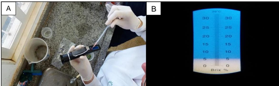
**Figura 16.** Determinación del teor de sólidos solubles en los frutos de la fresa, con refractómetro portátil expresando los valores en °Brix.
