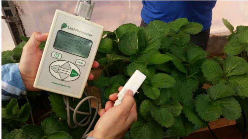
**Figura 12.** Porómetro foliar SC1 Dacagon Device evaluando la conductancia estomática de las hojas de la fresa.
