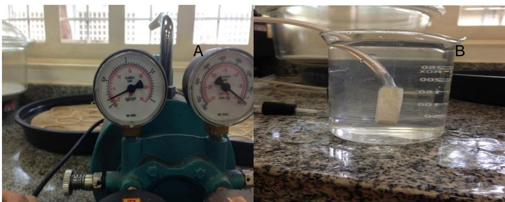
**FIGURA 5.** Teste para verificar o correto funcionamento do Irrigas sob pressão de 2 kgf cm<sup>2</sup> (A). Identificação de capsula com mal funcionamento (B).
