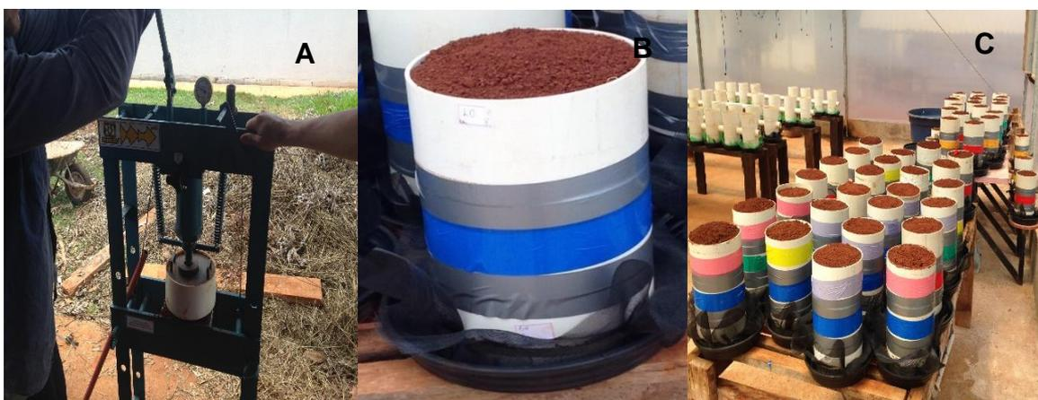
**FIGURA 2.:** Montagem das unidades experimentais Prensa da camada compactada (A); Unidade experimental montada B C).
