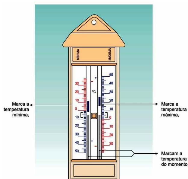
Figura 2: Termômetro de temperatura máxima e mínima
