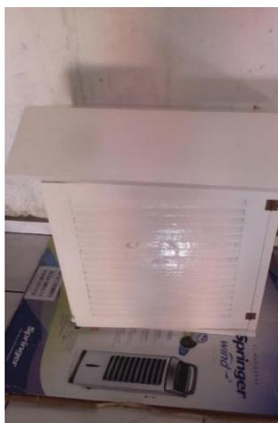
*Figura 1:* Abrigo de instrumentos meteorológicos
