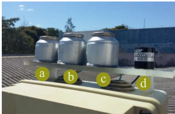
Figura 14 – Distribuição dos sensores para avaliação, (a) LDR, (b) BPW, (c) LED e (d) Quantum.
