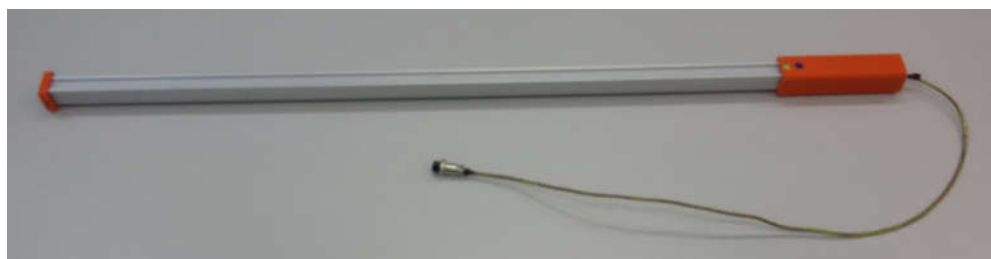
Figura 24 – Visualização da sonda responsável pela obtenção da RFA transmitida.
