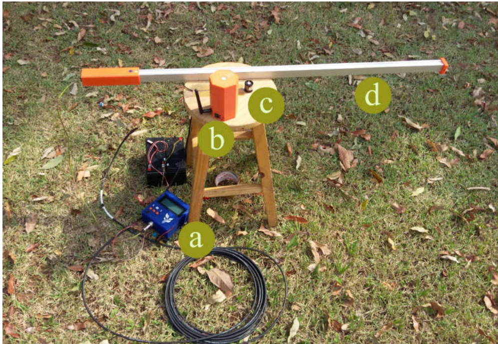
Figura 15 – Calibração do sistema desenvolvido, (a) Módulo principal, (b) Módulo Externo, (c) sensor Quantum e (d) Sonda.
