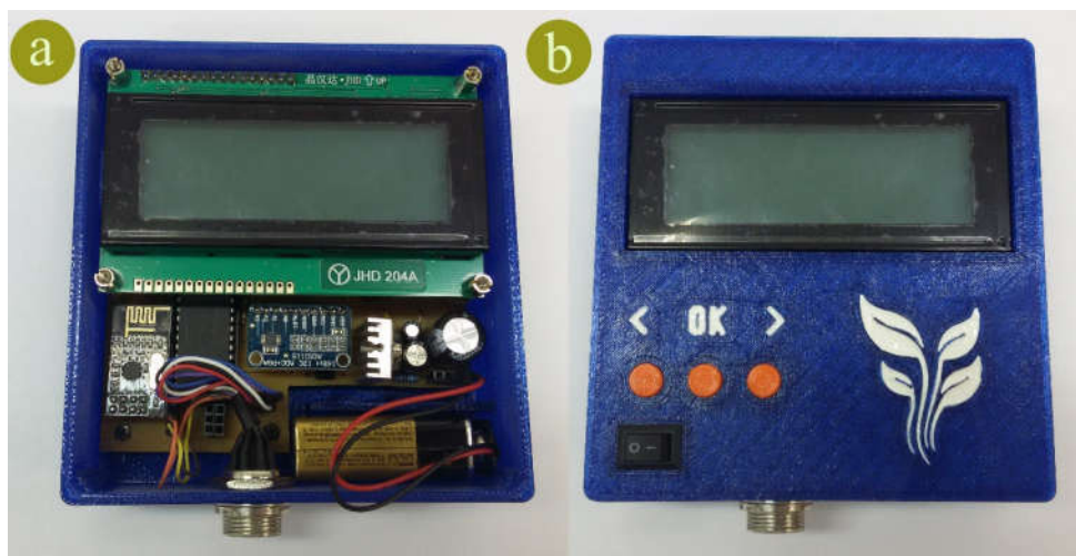
Figura 23 – Visualização do módulo principal (a) placa em circuito impresso e (b) visual externo do case.
