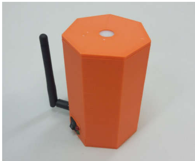
Figura 25 – Visualização do módulo externo responsável pela obtenção da RFA incidente.
