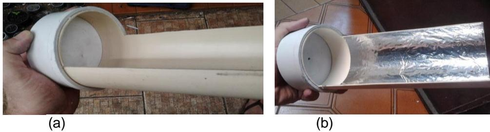
Figura A3.2: (a) Tubo de PVC de 100mm dividido ao meio com a tampa de PVC,
