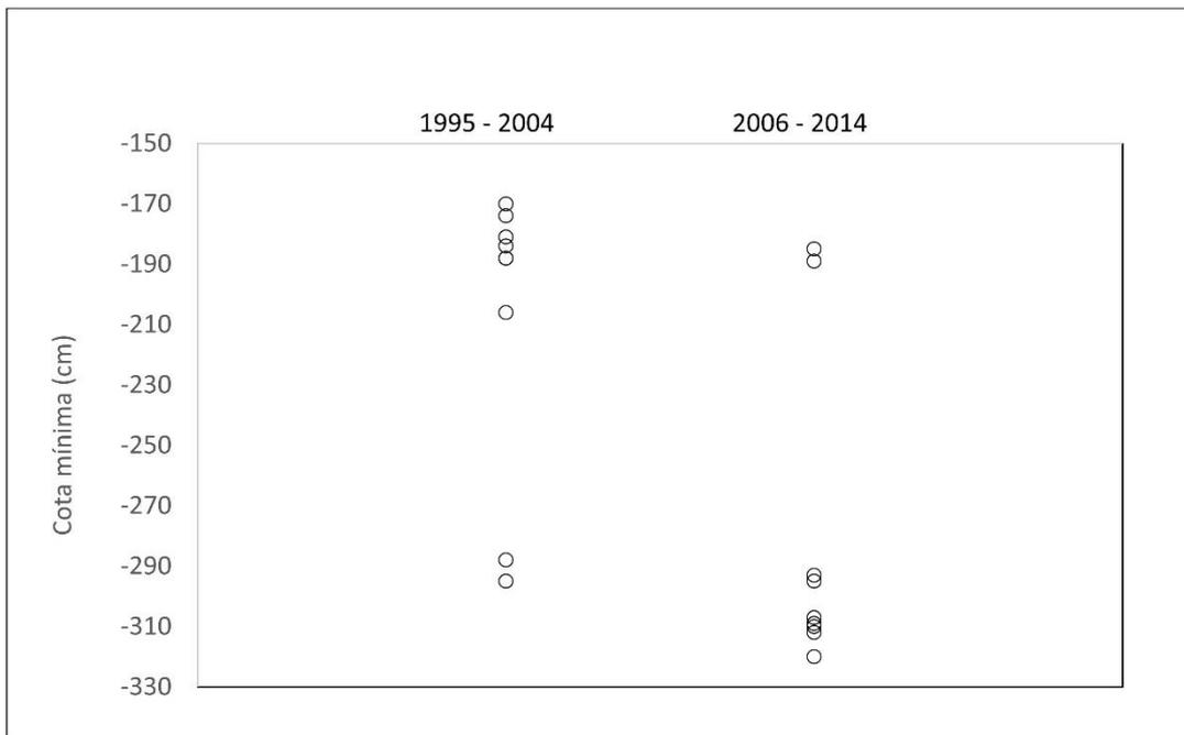
Figura 11 – Distribuição das cotas mínimas na seção a jusante da UHE Ponte de Pedra entre 1995 e 2014
