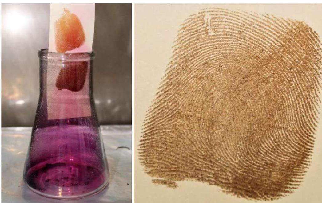
**Figura 13.** Procedimento de revelação de impressão digital pela sublimação do iodo.
