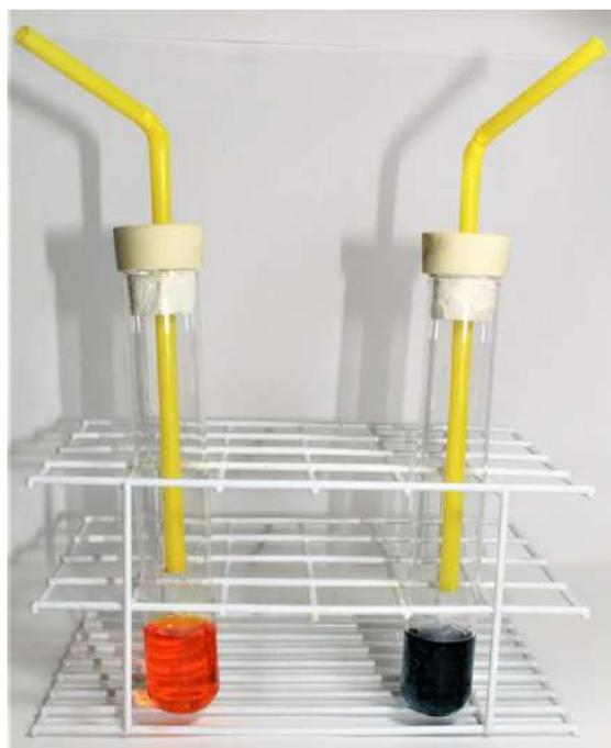
**Figura 47.** Resultado negativo (à esquerda) e positivo (à direita) da reação química que constitui o teste de alcoolemia com bafômetro descartável.
