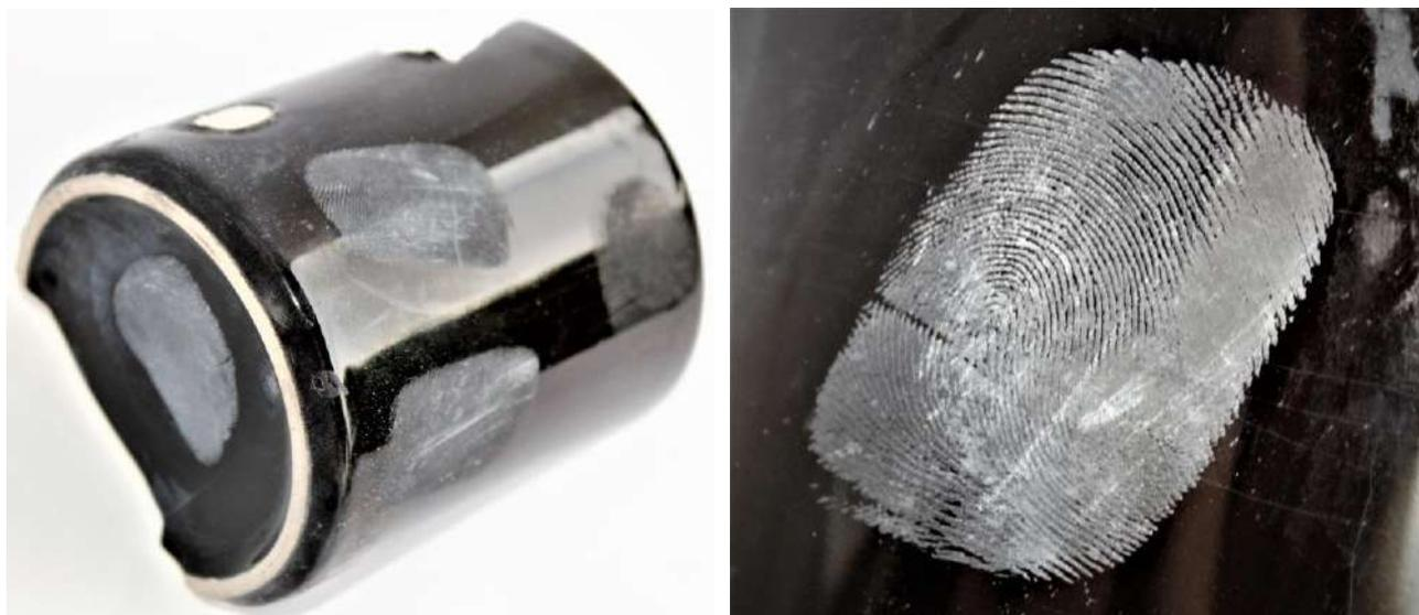
**Figura 22.** Combinação de métodos químicos e físicos de revelação de impressões digitais: uso de vapor de cianoacrilato e posterior aplicação de dióxido de titânio.
