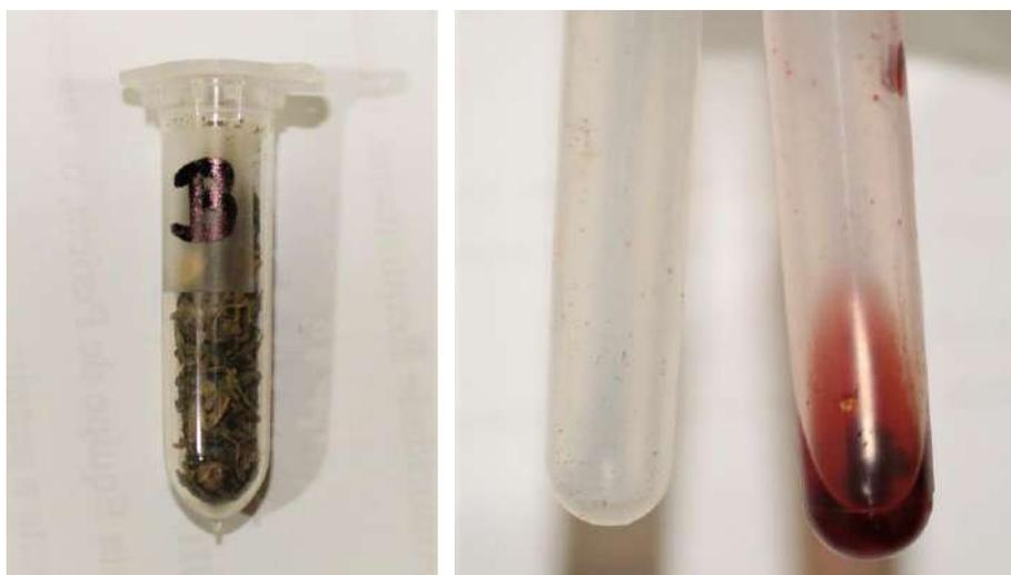
**Figura 36.** Amostra de maconha e teste *Fast Blue B* antes (à direita) e após (à esquerda) a adição de solução etanólica contendo a referida amostra, resultando em positivo para maconha.
