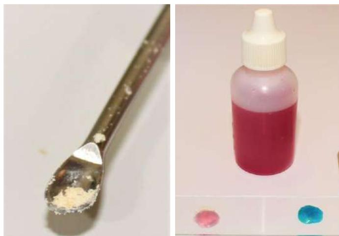
**Figura 33.** Amostra de pasta-base de cocaína e teste de Scott com resultados negativo e positivo, respectivamente.
