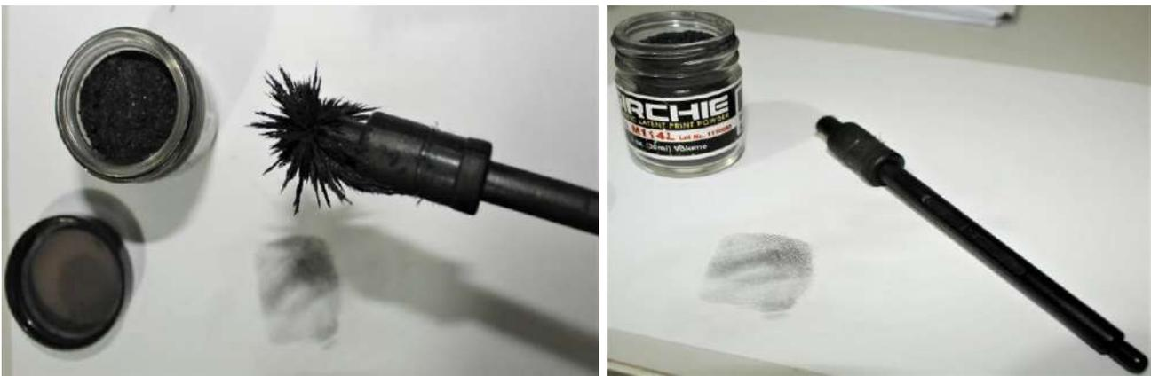
**Figura 11.** Pó magnético e pincel para revelação de impressões digitais.
