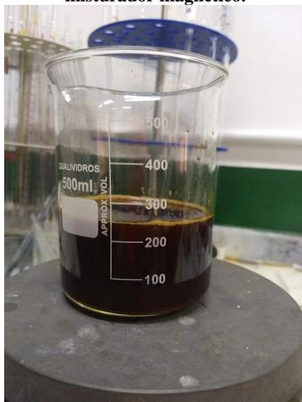
Finalizado o processo de mistura, a solução passou pelo controle de pH. A solução inicialmente apresenta um pH baixo, sendo assim necessário a adição de hidróxido de amônia ( $\text{NH}_4\text{OH}$ ) para elevarmos o pH até o valor desejado. Um medidor de pH foi utilizado neste processo, de tal maneira que o pH da solução foi constantemente monitorado a medida que gotas da solução de  $\text{NH}_4\text{OH}$  eram adicionadas.
