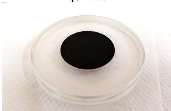
**Figura 4.7: Ferrita de cobalto em pastilha montada no porta-amostra, pronta para a medição por XRD.**
