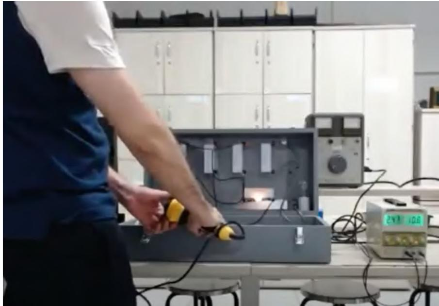
Figura 4.10: Captura de tela do vídeo no momento da geração de energia elétrica utilizando o gerador de corrente contínua.
