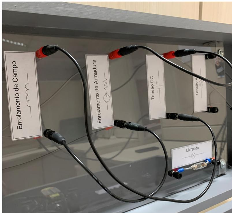
Figura 3.6: Conexão série dos enrolamentos da armadura e de campo do motor alimentados pela fonte de corrente contínua.
