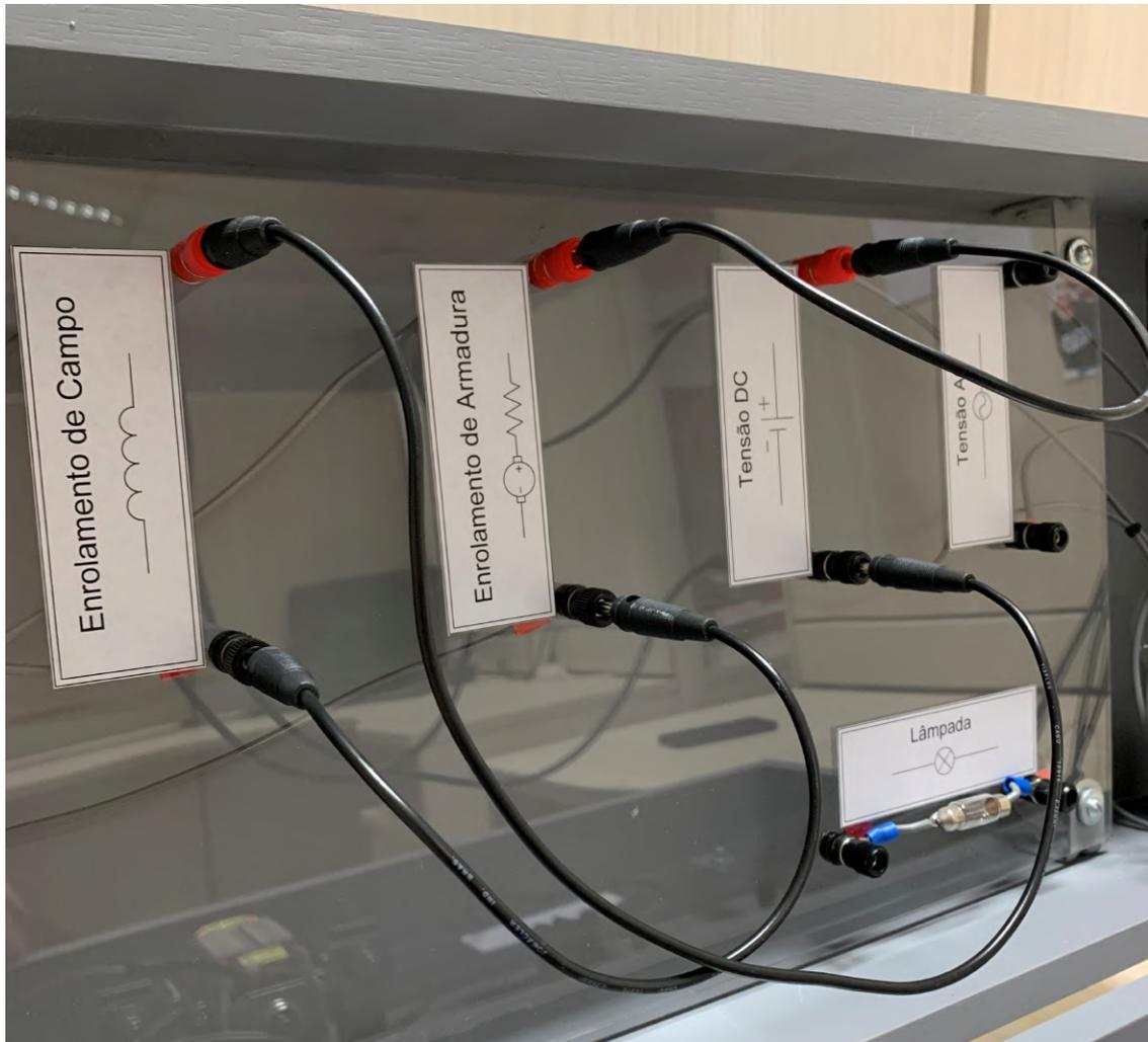
Figura C.3: Conexão série dos enrolamentos da armadura e de campo do motor alimentados pela fonte de corrente contínua.
