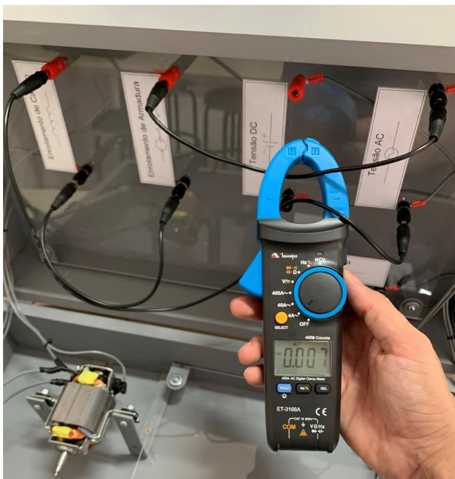
Figura C.14: Medição da corrente elétrica pelo alicate amperímetro.
