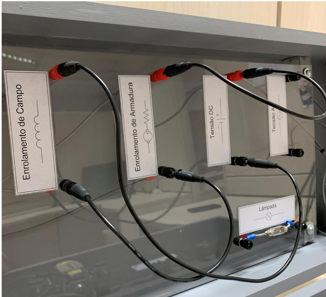
Figura C.10: Conexão série dos enrolamentos da armadura e de campo do motor alimentados pela fonte de corrente contínua.
