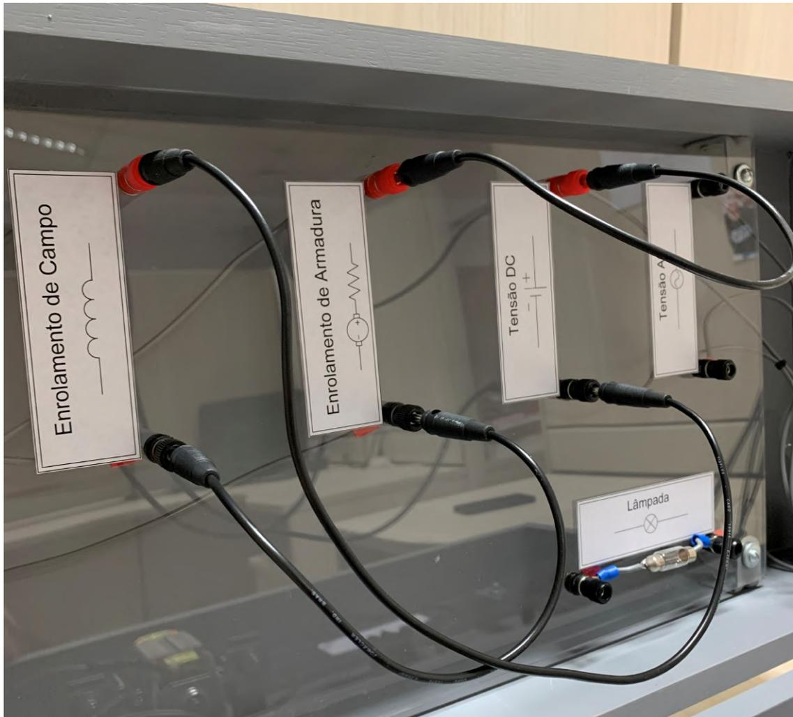
Figura 1.3: Conexão série dos enrolamentos da armadura e de campo do motor alimentados pela fonte de corrente contínua.
