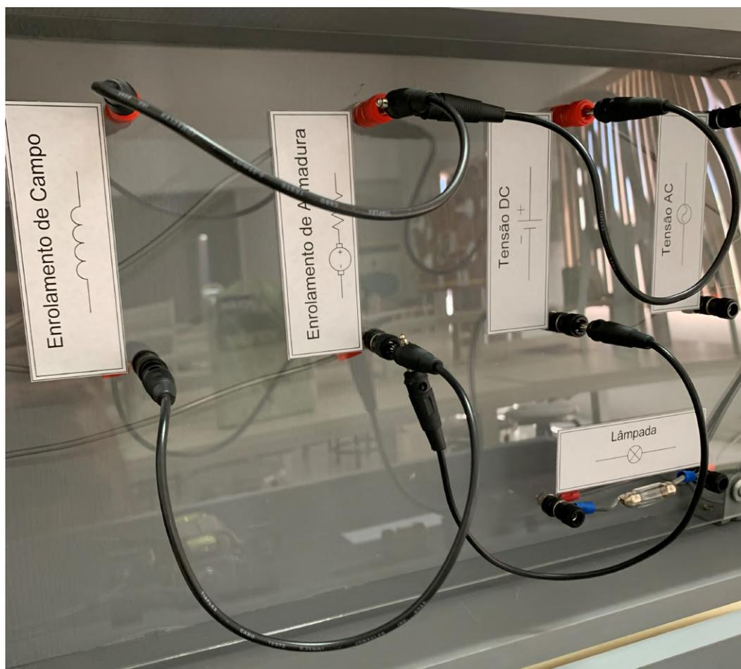
Figura 1.9: Conexão paralela dos enrolamentos da armadura e de campo do motor alimentados pela fonte de corrente contínua.
