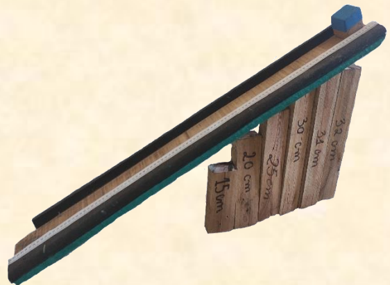
Figura 4: Equipamento Experimental Plano Inclinado com Atrito Fonte: Própria autoria.
