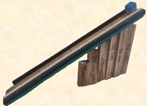
**Figura 4:** Equipamento Experimental Plano Inclinado com Atrito **Fonte:** Própria autoria.
