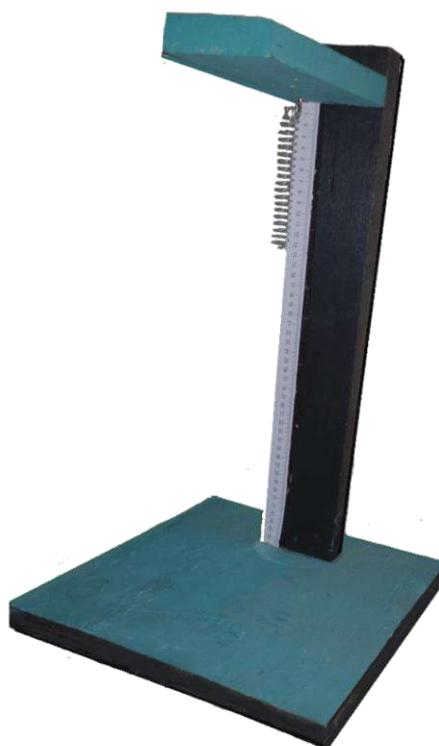
**Fig. 3:** Instrumento Didático para determinação da constante elástica  $k$  da mola.
