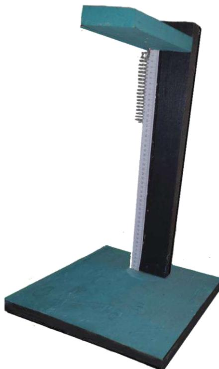
**Fig. 3:** Instrumento Didático para determinação da constante elástica  $k$  da mola.
