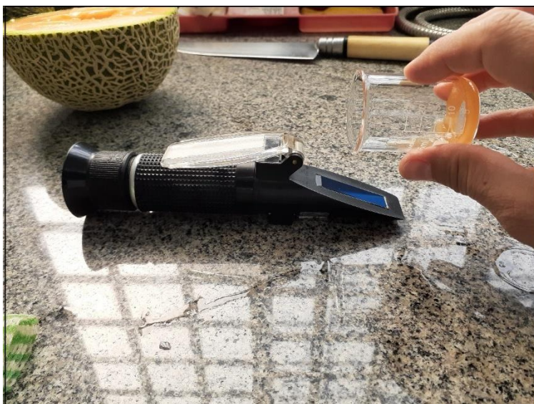
Figura 22. Determinação de conteúdo de sólidos solúveis totais em frutos de melão cantaloupe com uso de refratômetro.
