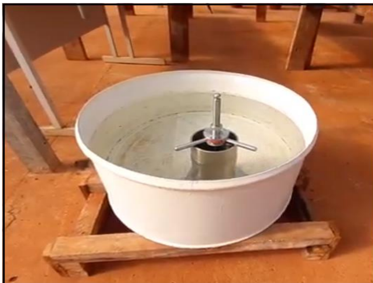
Figura 10. Tanque classe A reduzido instalado na estufa agrícola.
