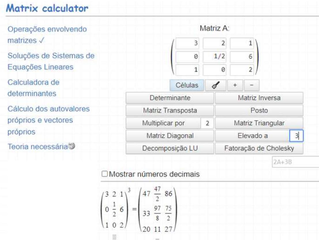
Figura 1.5: Layout *Matrix Calculator* - Cálculo de Potência
