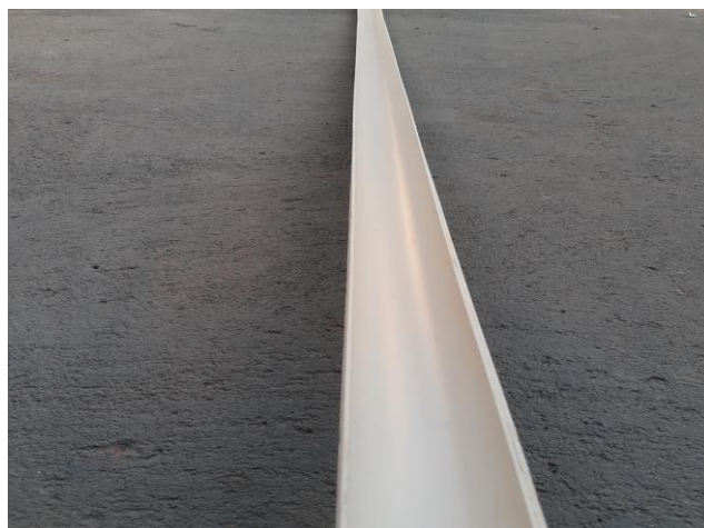
Figura 14 – Foto das canaletas coladas uma sobre a outra.
