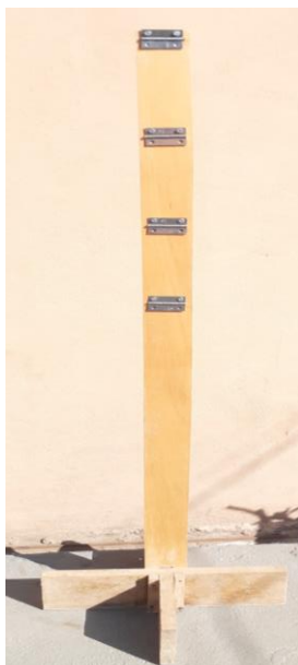
Figura 13 - Haste vista de frente com as 4 dobradiças que servem de suporte para o plano inclinado.
