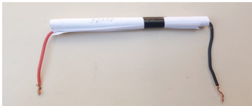
Figura 32: Capacitor enrolado bem apertado.
