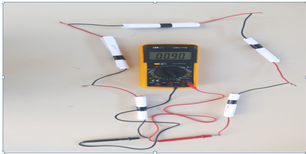
Figura 38: Medida da capacitância do circuito em série.
