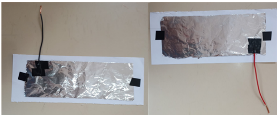
Figura 29: Eletrodos conectados nas placas do capacitor.
