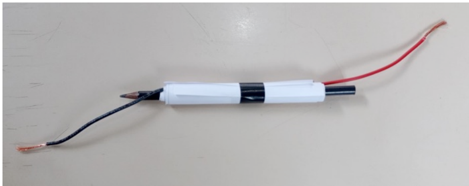
Figura 31: Capacitor enrolado bem apertado.
