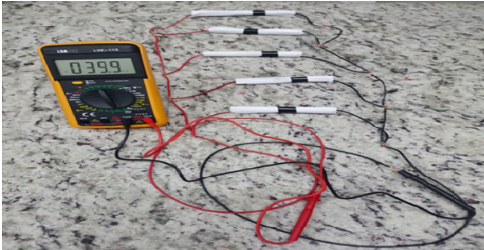
Figura 36: Medida da capacitância do circuito em paralelo.
