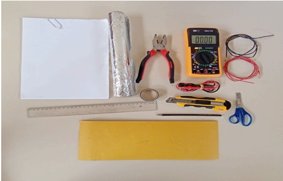
Figura 23: Materiais necessários para construção do capacitor de papel.
