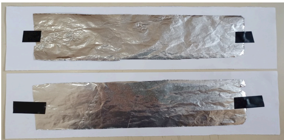
Figura 28: Fixação das placas no dielétrico.
