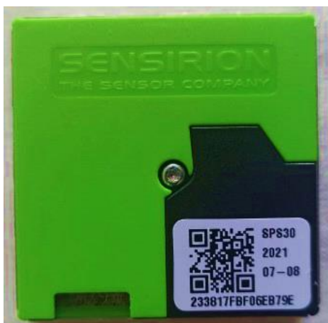
FIGURA 12- Sensor SPS30. FONTE: (Autor).
