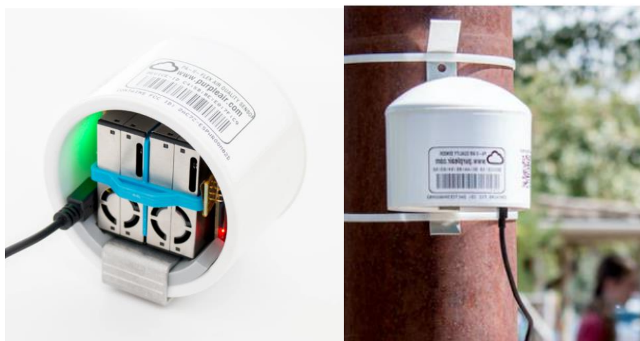
FIGURA 2- Monitor de qualidade do ar externo / PurpleAir PA-II. FONTE: (PurpleAir).
